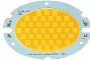
Şekil 4. 10 : COB LED örneği.
