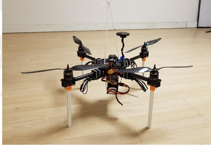
Şekil 5. Hava robotunun tüm ekipmanlar monte edilmiş hali
