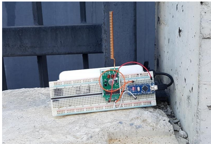
Şekil 28. Hedef olarak kullanılan radyo verici devresi
