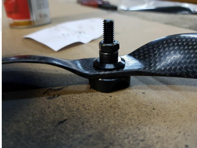
Şekil 18. Pervane adaptörü ve pulun montajlı hali
