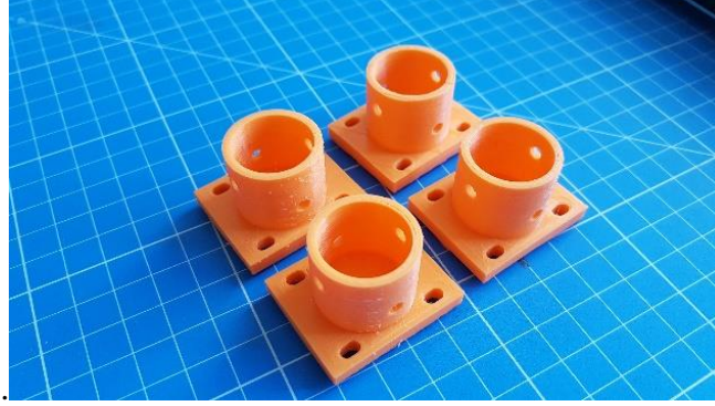
Şekil 17. İniş ayakları gövde montaj parçası
