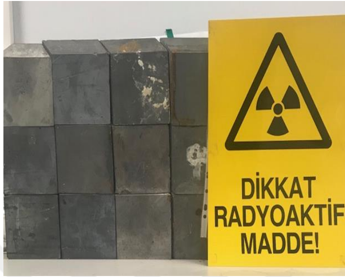
Şekil 4.18 : Kurşun bloklardan oluşan hücre sistemi.
