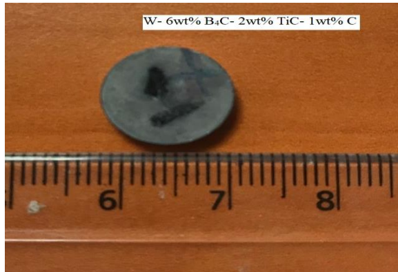
Şekil 4.7 : W- % ağı. 6 B_4C - % ağı. 2TiC- % ağı. 1C kompozit malzemelerin genel görünümü.
