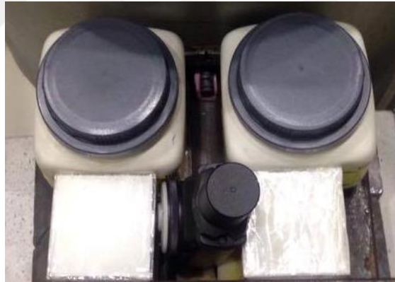
Şekil 4.23 : H_3BO_3 (borik asit) elemanlarından oluşturulan kolimatör sistemi.
