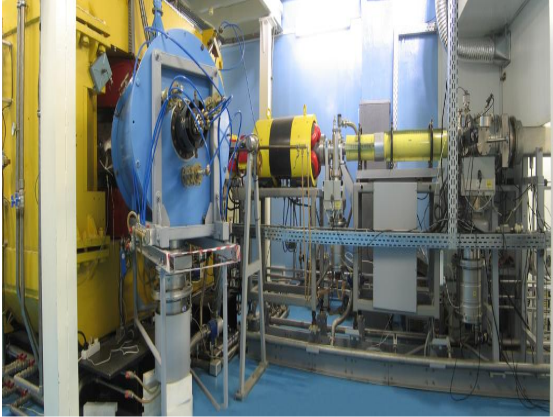
Şekil 4.26 : IC-100 aksenal enjeksiyon kanalının görünümü.
