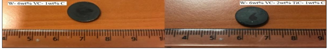
Şekil 4.1 : W- % ağı. 6 VC- % ağı. 1 C ve W- % ağı. 6 VC- % ağı. 2TiC- % ağı. 1C kompozit malzemelerin genel görünümü.
