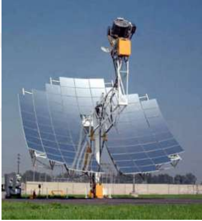
Şekil 1.19 : Parabolik Çanak Tip Kolektör Uygulaması [21].
