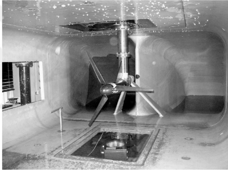
Şekil 2.3 : Su tüneline dinamometreye bağlı prototip türbin [6].
