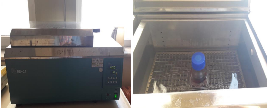
Şekil 2.2. Kırmızı pancardan su banyosu ile renk maddesi ekstraksiyonu
