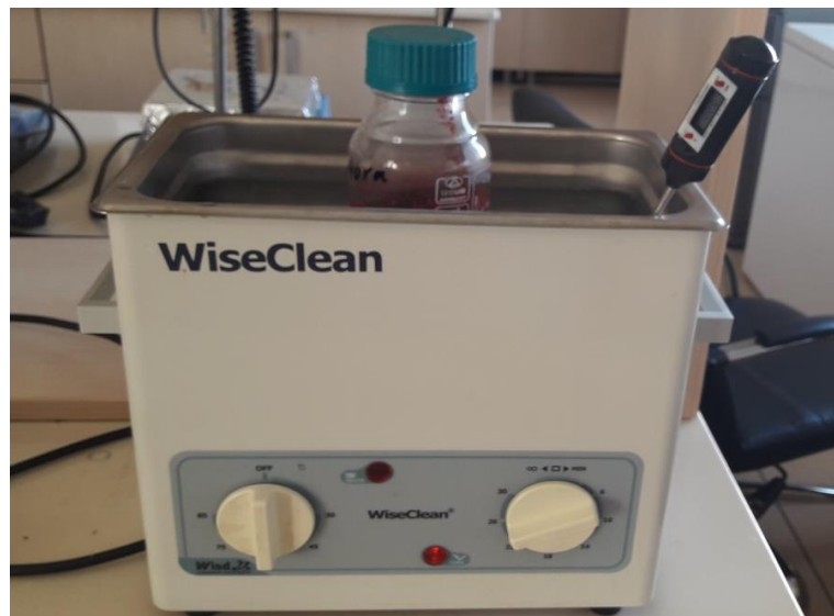
Şekil 2.6. Kırmızı pancardan ultrasonikasyon ile renk maddesi ekstraksiyonu
