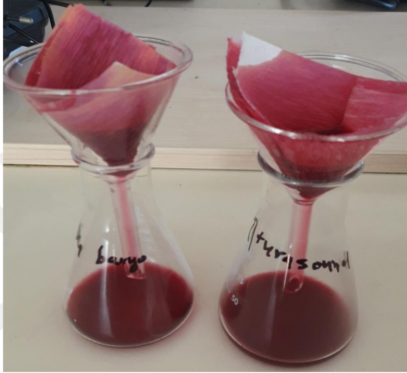
Şekil 2.8. Toz örneklerden betalain ekstraksiyonu
