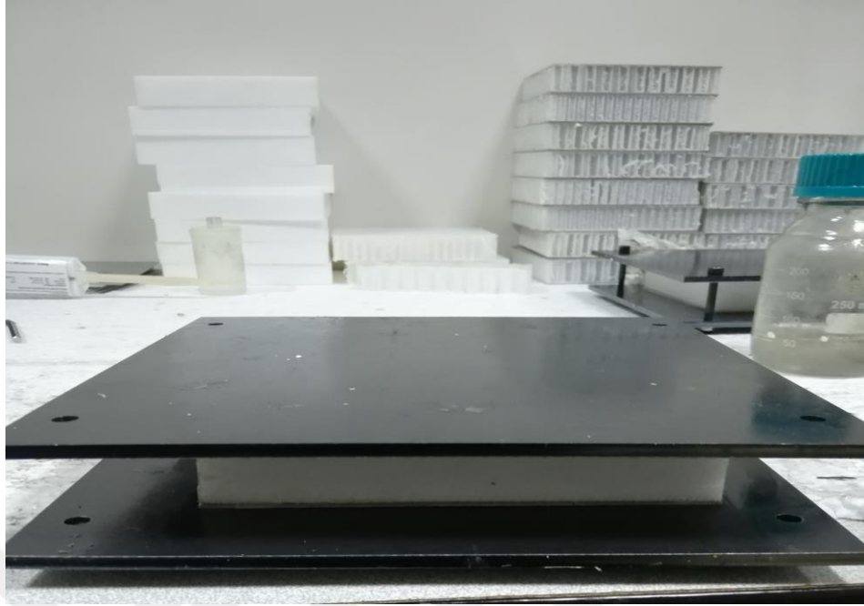
Şekil 2.12. Parafin sürülmüş kalıp yüzeylerle sandviçin kapatılması
