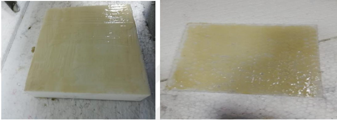
Şekil 2.11. XPS köpük ve PP bal peteği üzerinde uygulanmış epoksi
