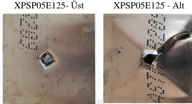
Şekil 3.4 Çekirdek malzemesi XPS olan sandviç panelin 125 J darbe enerjisi için, darbe sonrası hasar görüntüsü (Plaka kalınlığı 0,5mm)
