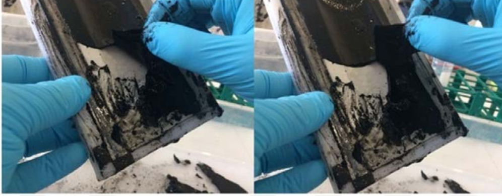
Şekil 20. AnMBR'de kek sıyırması sırasında çekilen görseller
