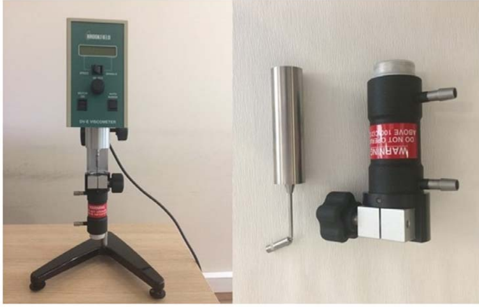
Şekil 24. Çalışmadan kullanılan viskozite metre ve kullanılan spindle (başlık)
