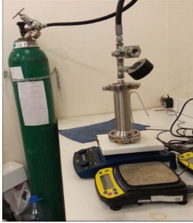
Şekil 15. SRF ve SF analizlerinde kullanılan dead-end filtrasyon sistemi
