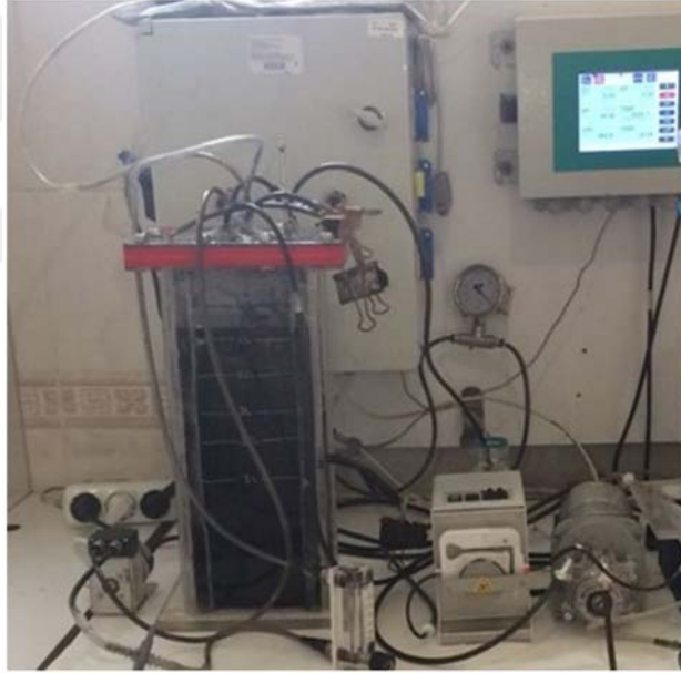
Şekil 6. Kurulan AnMBR sistemine ait fotoğraf
