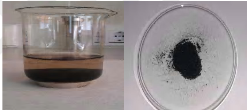
Şekil 6.7. Mıknatıs yardımıyla çöktürölmiş ve kurutulmuş nanoparçacıklar
