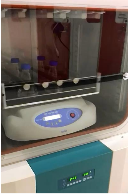
Şekil 8. 25°C’de ve 50°C’de enzimatik degradasyon ve biyorejenerasyon deneylerinde kullanılan çalkalamalı ısıtıcılar
