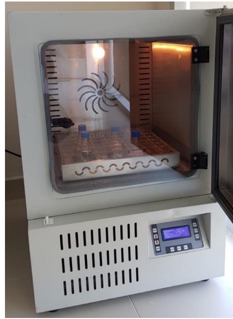
Şekil 8. 25°C’de ve 50°C’de enzimatik degradasyon ve biyorejenerasyon deneylerinde kullanılan çalkalamalı ısıtıcılar
