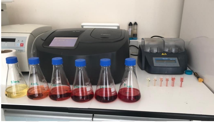
Şekil 9. 4-AAP metoduyla fenol için konsantrasyon kalibrasyonunun belirlenmesi çalışmaları
