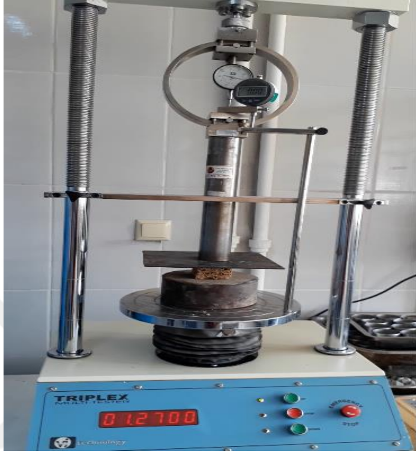
Şekil 3.17 Tüfleşmiş Kalker Numunesi İçin CBR Deneyi
