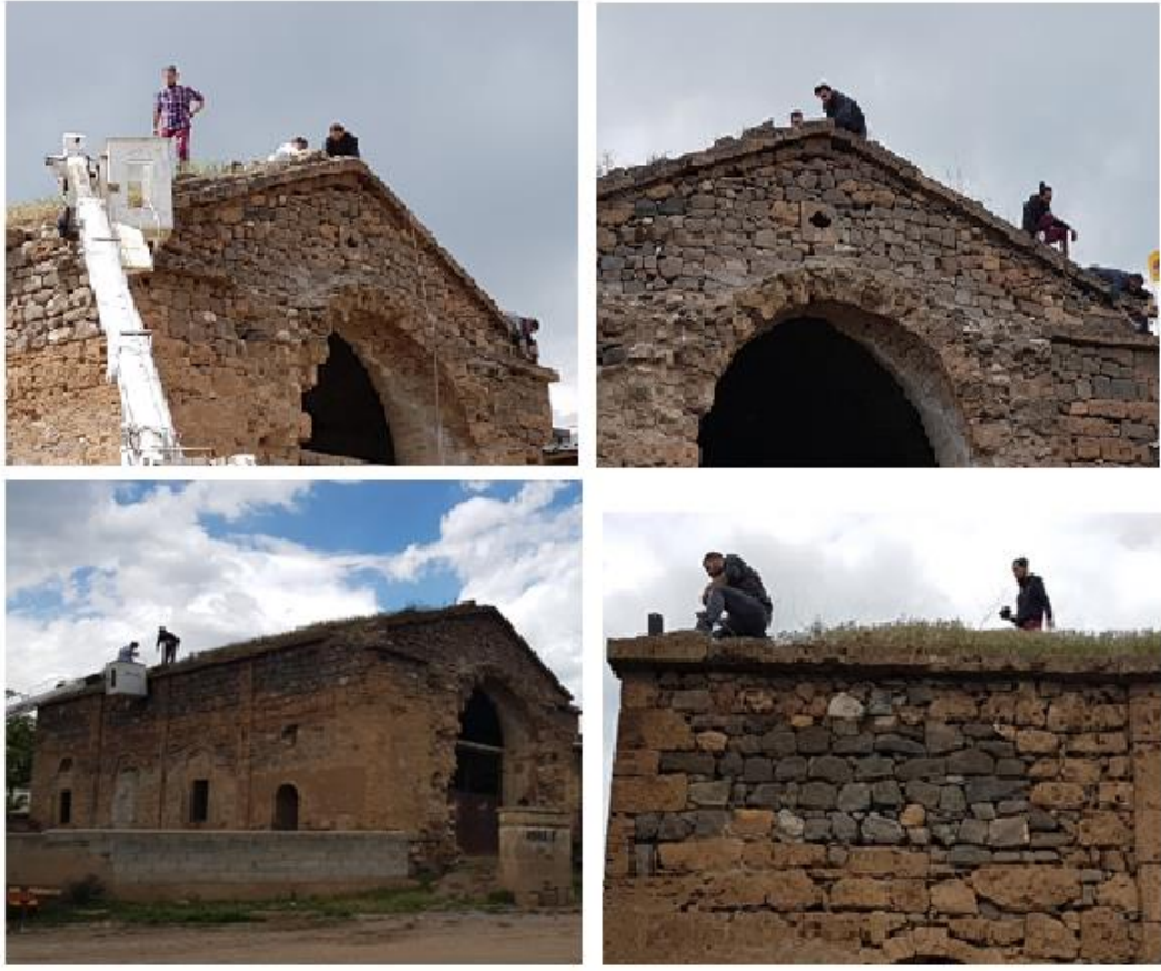
Şekil 3.40 Operasyonel Modal Analiz İçin Yapılan Titreşim Ölçümlerinden Görüntüler
