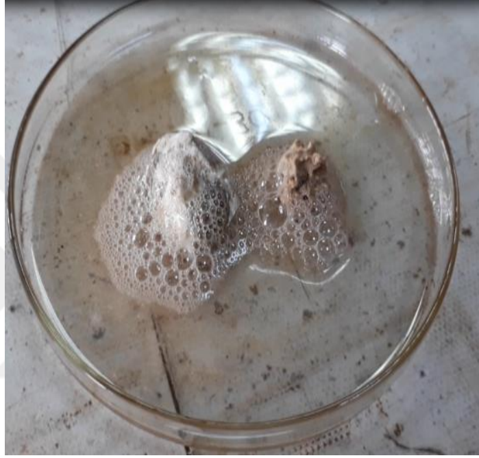
ekil 3.18. Tflemi Kalker Numunesi İin Yoėunluk Testinden Bir Grnt
