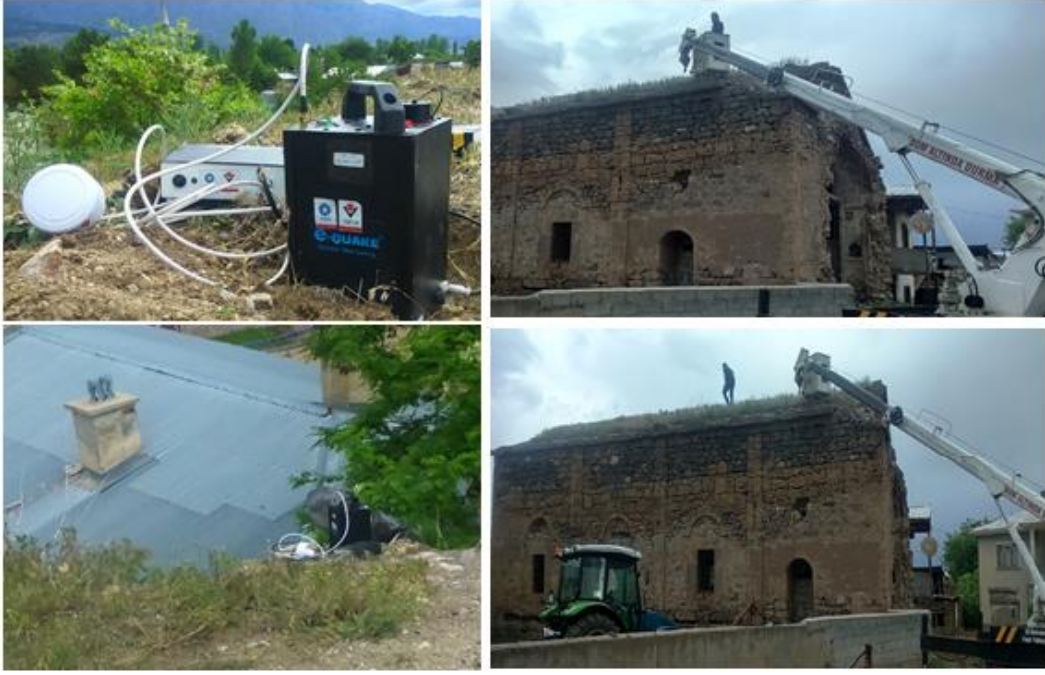
Şekil 3.39 Arazide Gerçekleştirilen Yapısal Titreşim Kayıt Çalışmaları
