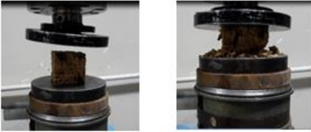
Şekil 3.16 Tüfleşmiş Kalker Numunesi İçin Basınç Dayanım Testi
