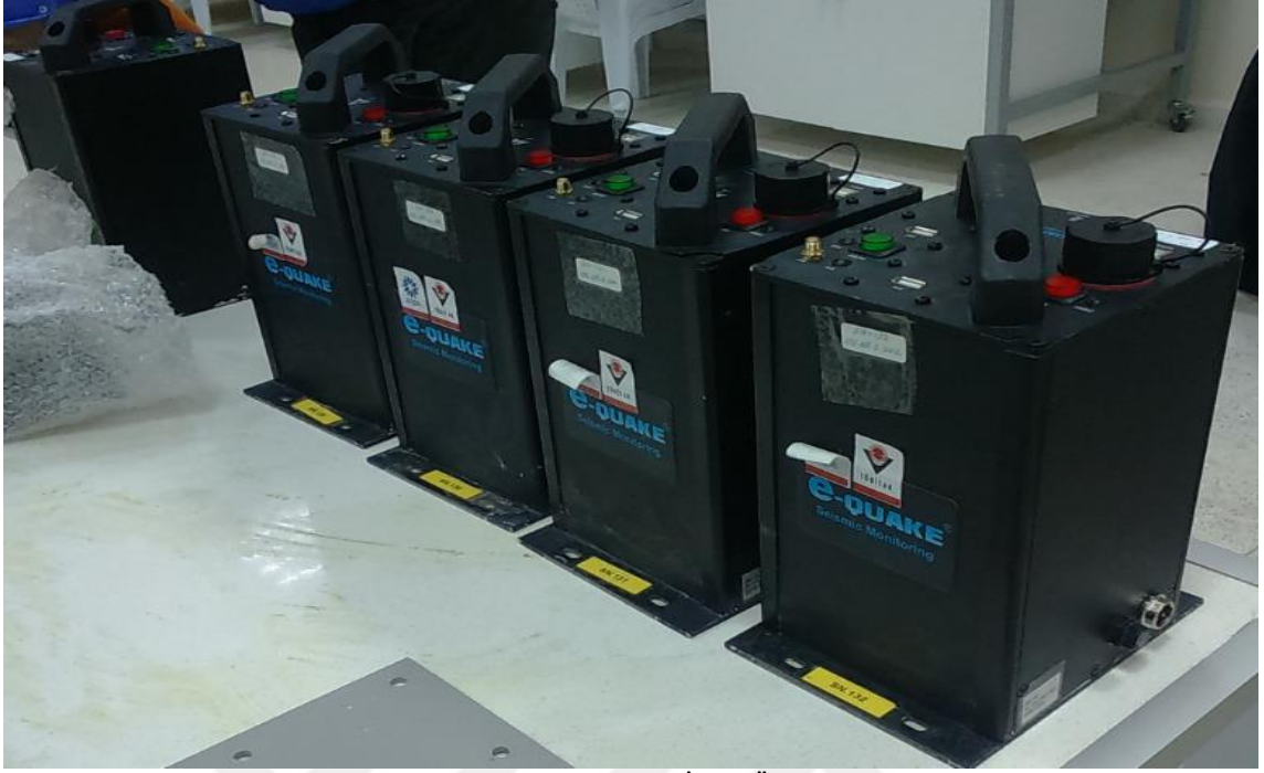
Şekil 3.38 Kablosuz 3 Eksenli İvme Ölçüm Cihazları
