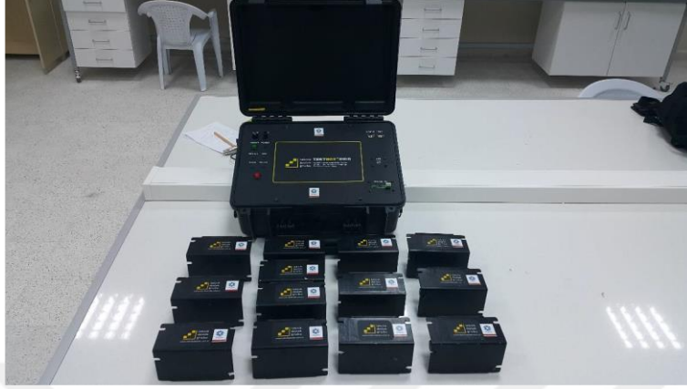
Şekil 3.26. Tek eksenli ivmeölçerler ve taşınabilir veri toplama sistemi
