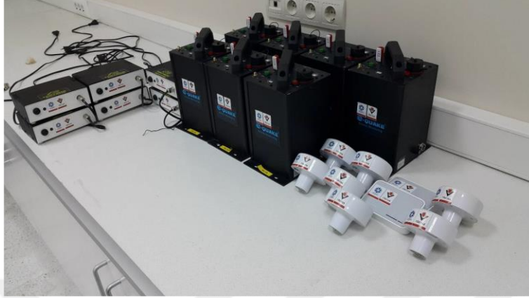
Şekil 3.25. Ultra hassas kuvvetli yer hareketi kayıt cihazları, GPS alıcıları ve bataryalar
