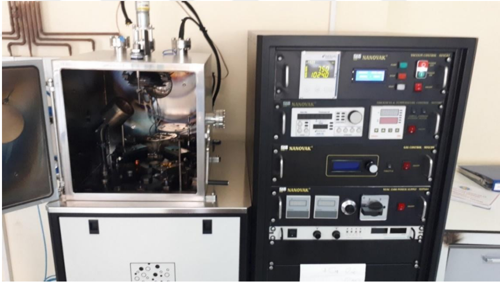
Şekil 3.1 Buharlaştırma için kullanılan vakumlu metal buharlaştırma ünitesi
