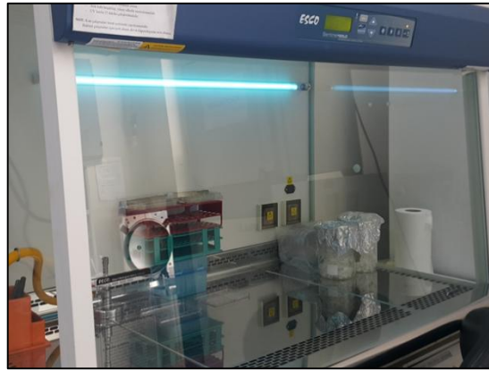
Şekil 4.4. Steril kabin içerisinde UV radyasyonuna maruz bırakılan sporlar
