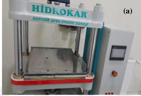
Şekil 3.9. a) Hidrolik pres, b) Kürleşme sonrası TAST numuneleri.
