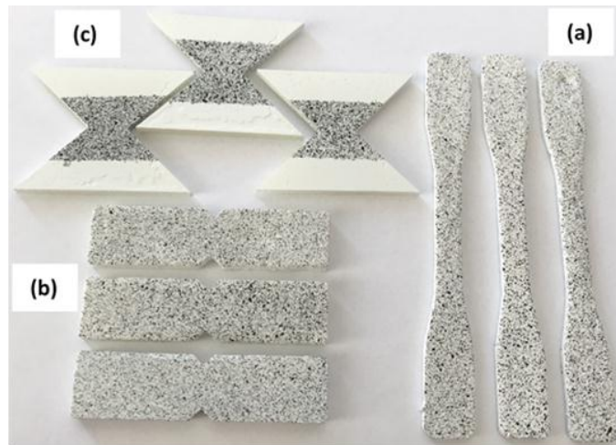
Şekil 3.4. Numune yüzeylerinde oluşturulan noktasal yapılar; a) çekme numunesi, b) Iosipescu, c) Arcan.
