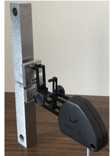
Şekil 3.7. a) ASTM D5656 ve ISO 11003–2 kullanılarak modifiye edilmiş numune boyutları, b) kontak ekstensometre.
