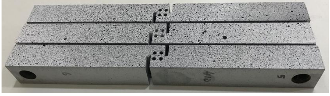
Şekil 3.10. TAST numune yüzeylerinde oluşturulan desenler.
