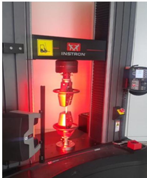
Şekil 3.5. INSTRON çekme cihazı ve AV 2 video extensometre.
