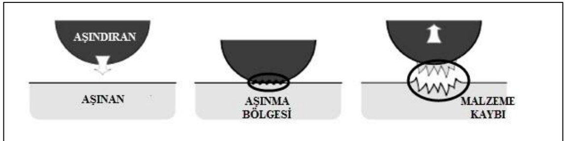
Şekil 1. 25 Adhesiv aşınma esnasındaki malzeme transferi.
