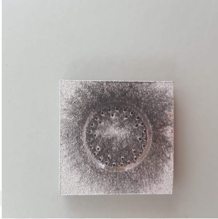
Şekil 4.13 Aşınma testinden çıkan 7 no'lu analize ait numune görüntüsü
