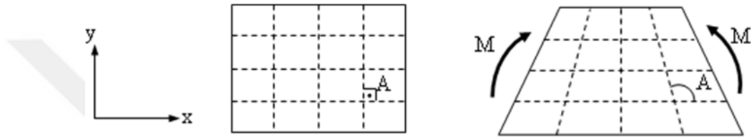
Şekil 1.22 SOLID65 elemanın eğilme momenti etkisinde şekil değiştirmesi.
