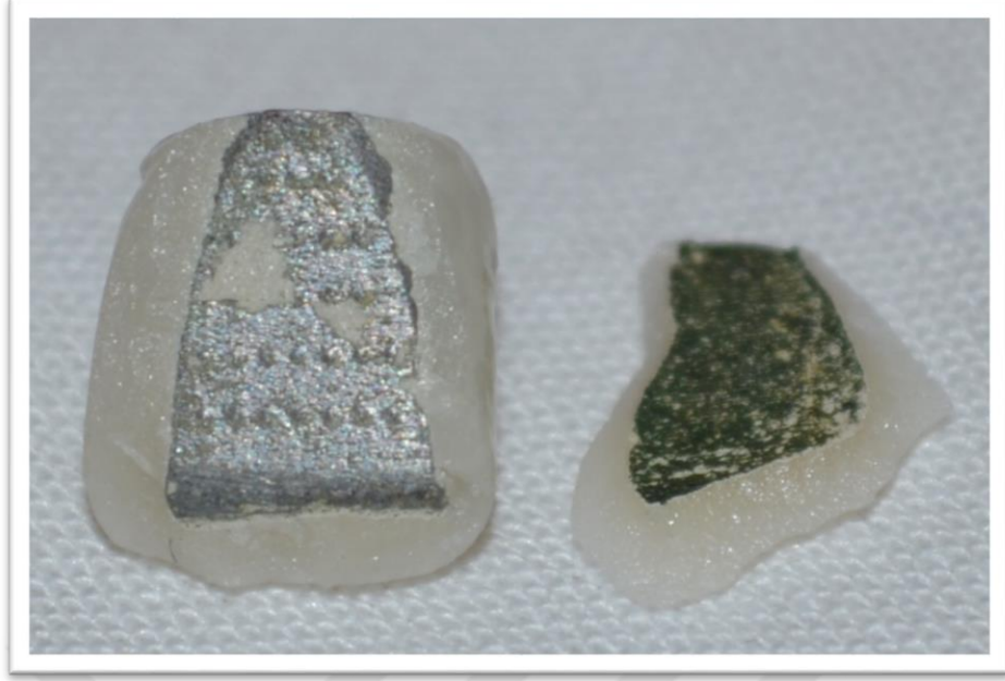
Şekil 4.7 Statik test sonrası sıkı dizilimli kuron
