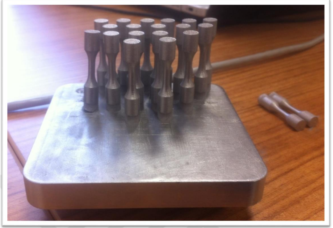
Şekil 3.4 Üretim sonrası elde edilen CoCrW alaşımlı Yorulma Numuneleri
