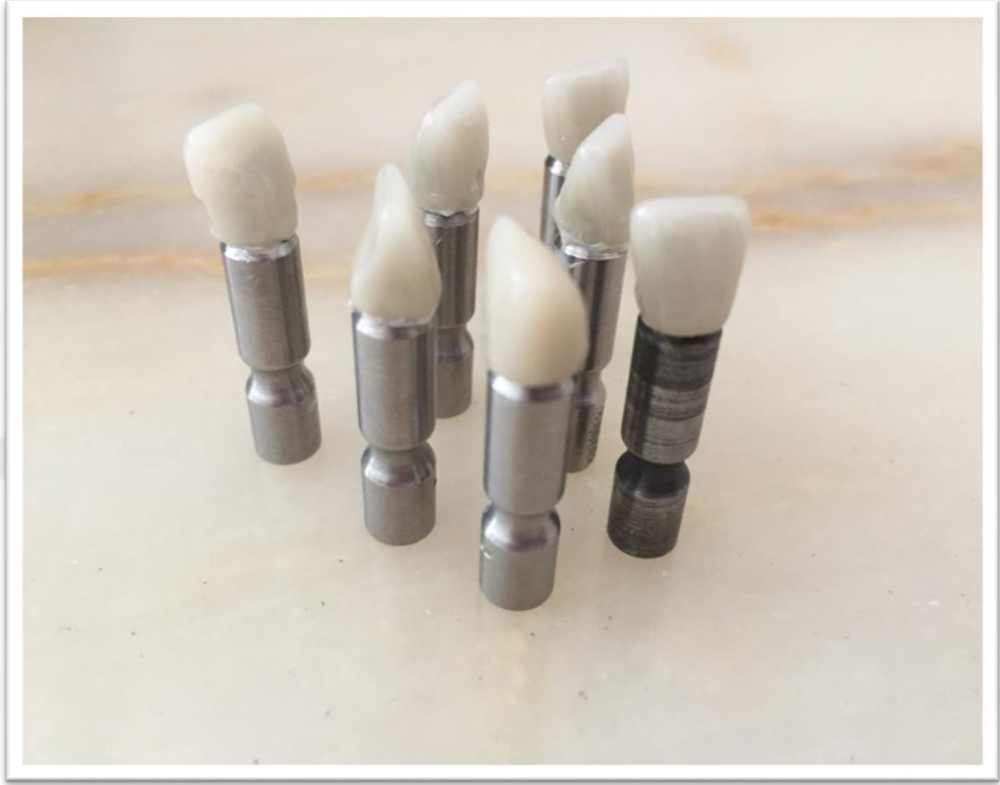
Şekil 3.15 Çelik day üzerine yapıştırılmış metal alt yapılı seramik kuronlar
