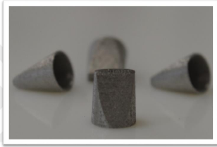
Őekil 4.1 Üretim sonrası elde edilen dikensiz boř kuron
