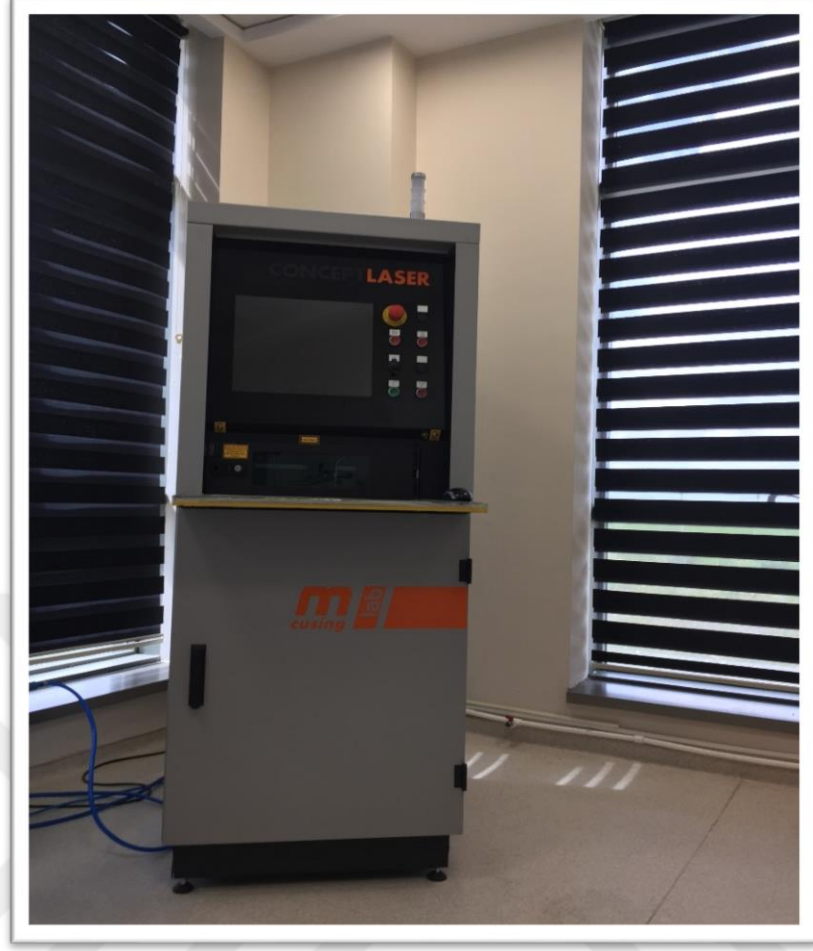
Şekil 3.1 Üretim için kullanılan seçici lazer ergitme cihazı
