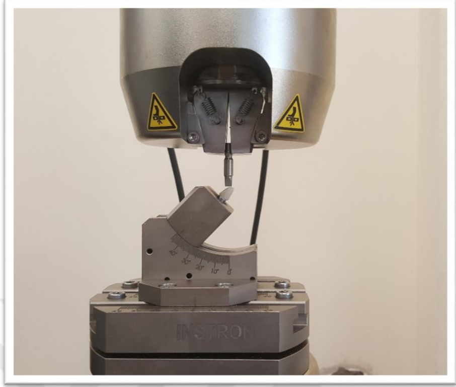
Şekil 3.18 Deney numunesinin cihaza bağlanması
