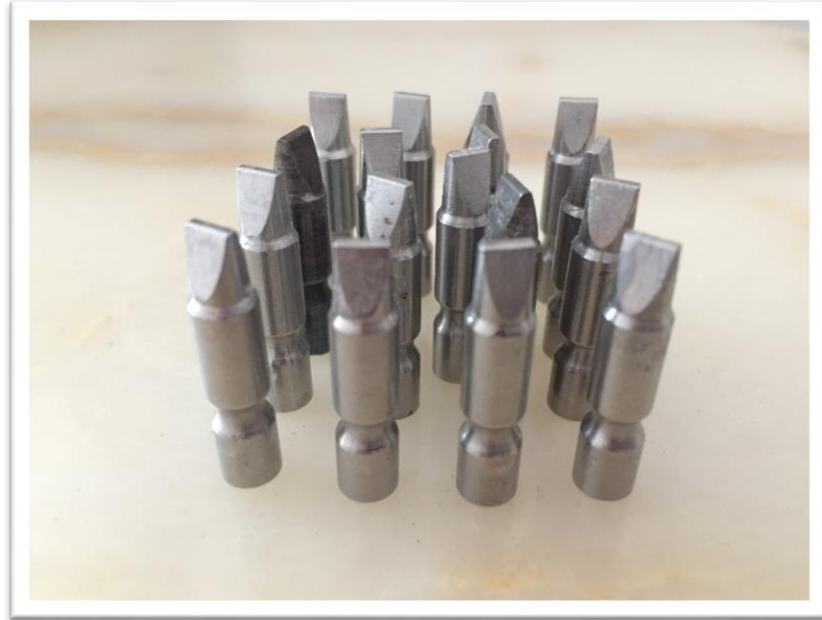
Şekil 3.6 Üretim sonrası elde edilen çelik daylar
