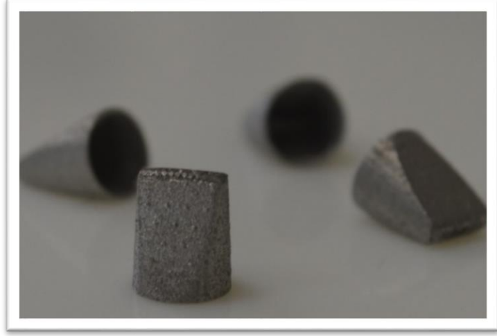
Şekil 4.3 Üretim sonrası elde edilen normal dizimli kuron
