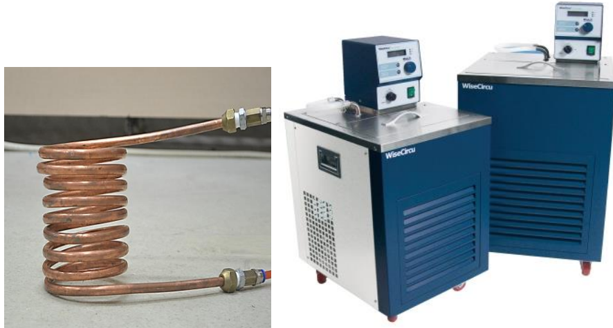
Şekil 3. 9. Serpantin ve sirkülatörlü su banyosu
