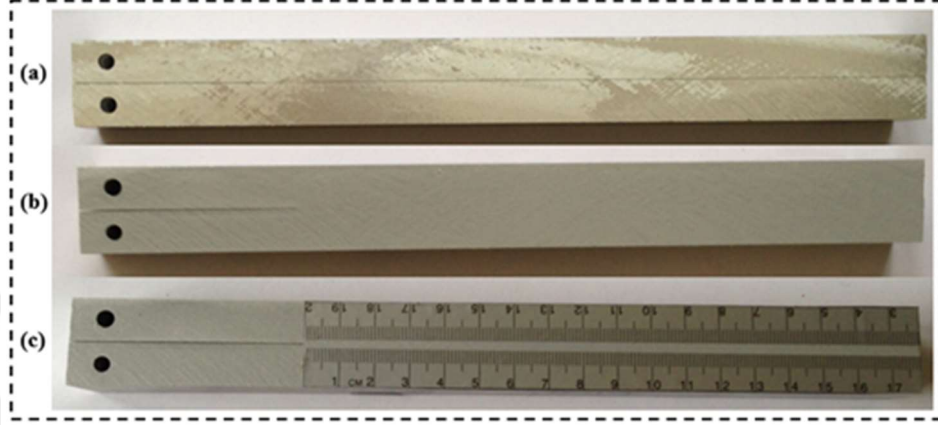
Şekil 3.3. Çift Konsol Kiriş Bindirme Bağlantısının Hazırlanması a) DCB Bağlantı Numunesi, b) Yüzeyi Spreyci Boya İle Kapatılması, c) Yüzeyine Mezura Yapıştırılması
