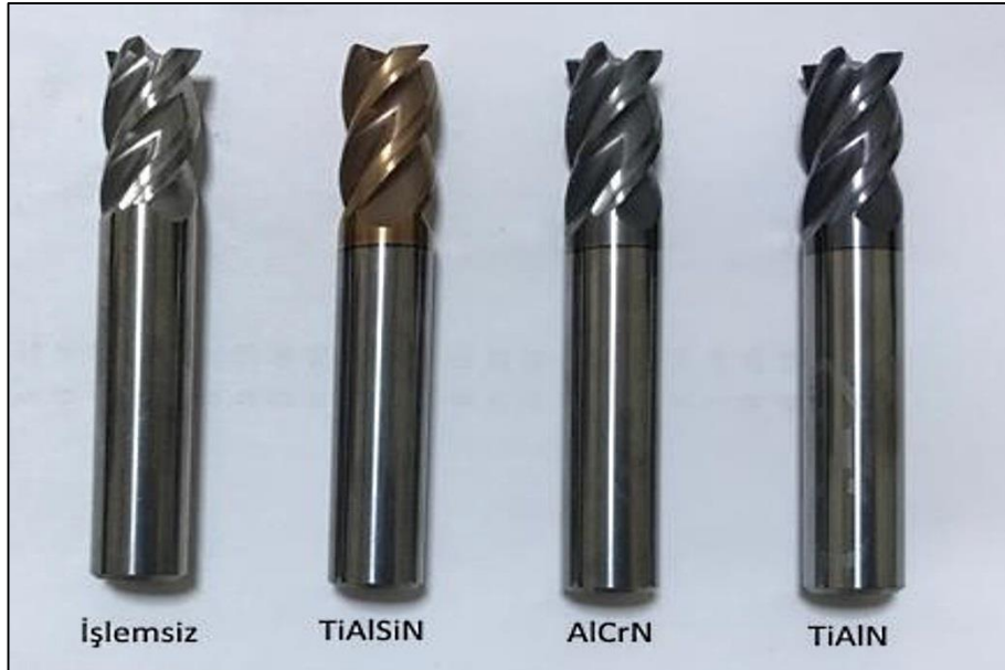
Şekil 3.1 İşlemsiz ve kaplanmış kesici takımlar.
