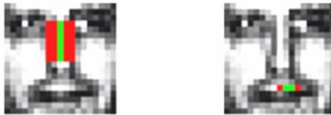
Şekil 3.8. AdaBoost ile belirlenen uygun öznitelik (solda) ve uygun olmayan öznitelik (sağda)(Lazebnik ve Viola, 2016)
