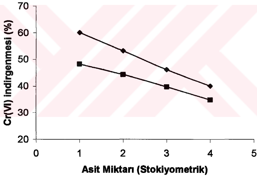
Şekil 6.2. Derişik ortamda Cr(VI) indirgenme verimine pirit miktarının ve ortamın asit konsantrasyonunun etkisi (◆; 2,5 g HP ■ ; 1,25 g HP)
