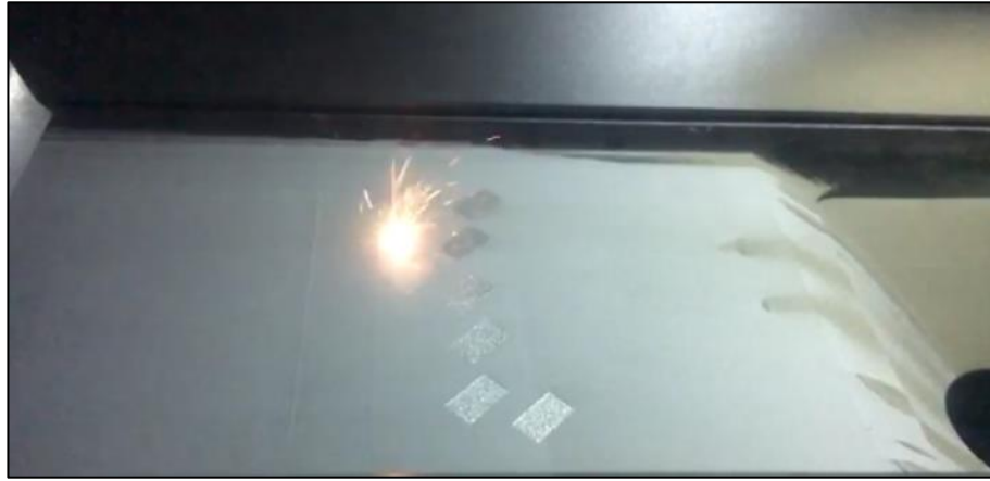
Şekil 3.4. SLE süreci esnasında üretim platformunun görüntüsü
