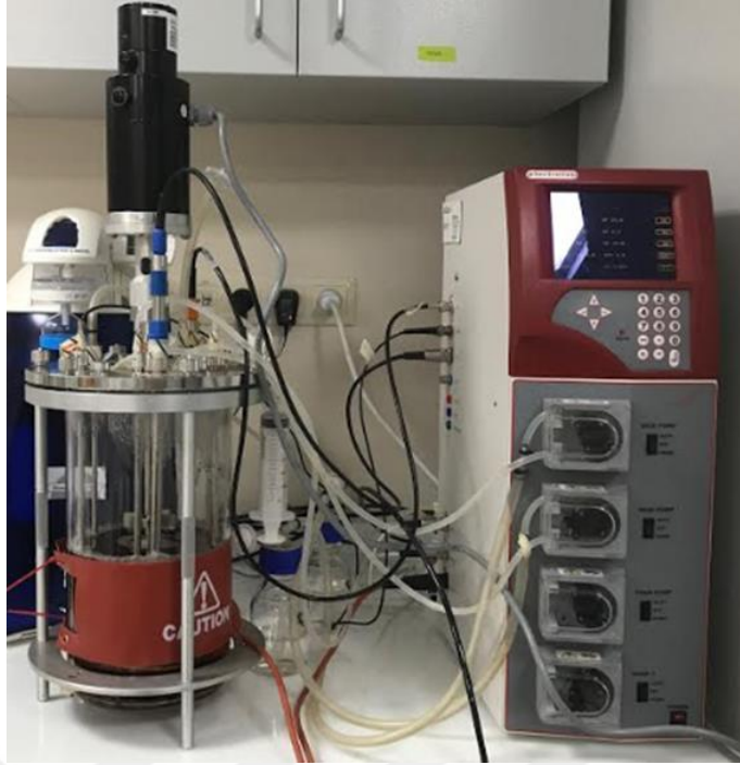
Şekil 3.1. Filamentöz Fungusun Geliştirildiği Fermentör Sistemi
