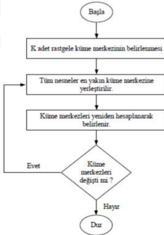
Şekil 1.13. K-ortalama algoritmasının akış diyagramı (The flowchart of K-means algorithm) [2]
