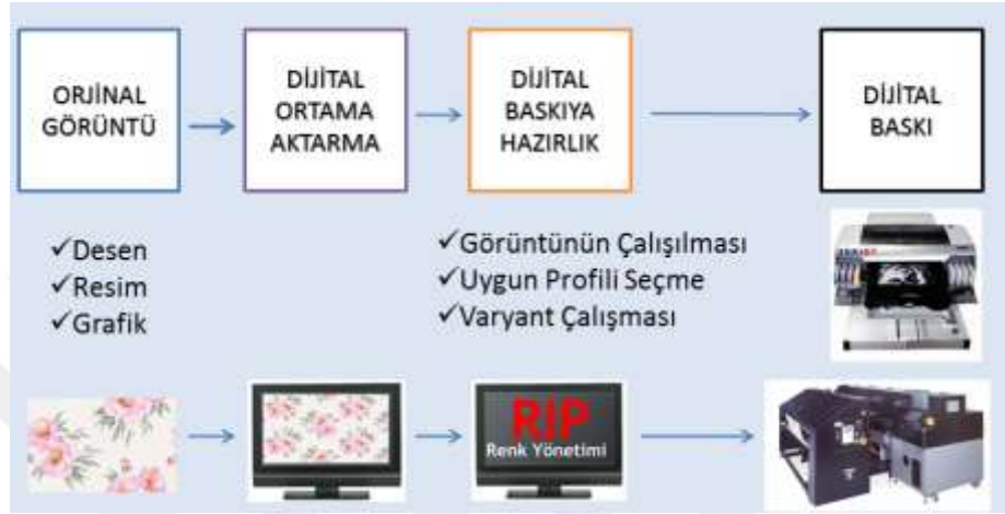
Şekil 1.3. Dijital Baskı Prosesi Akış Şeması [8]
