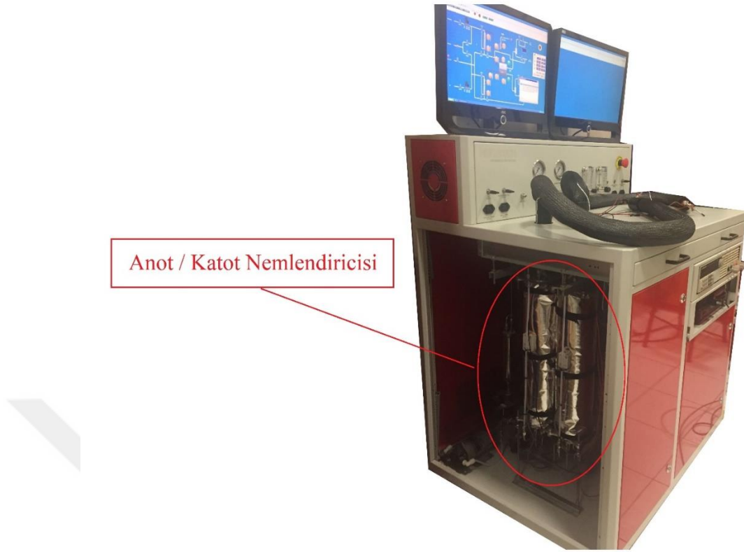
Şekil 3. 12. Test istasyonu nemlendirme ünitesi
