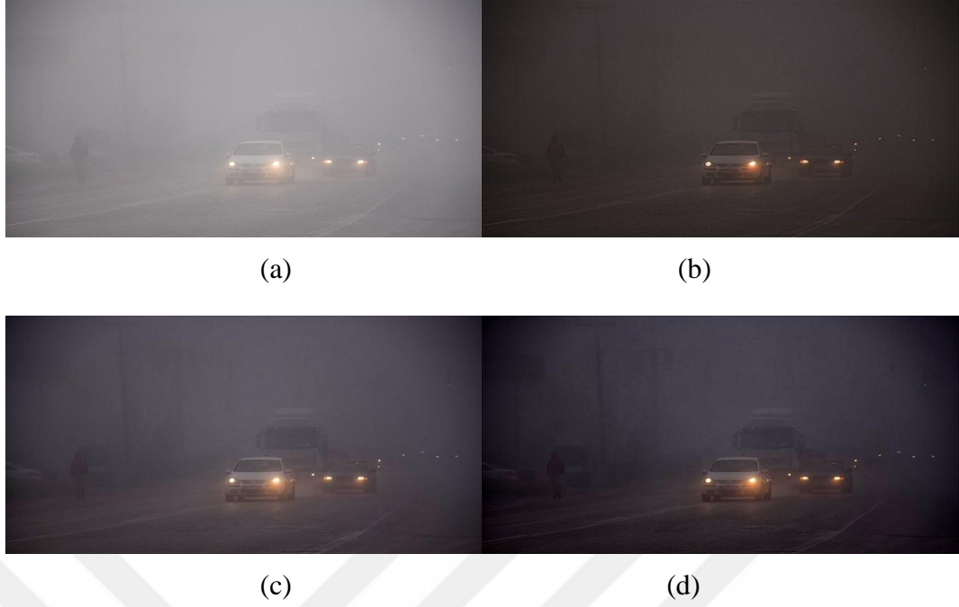
Şekil 4.22 Sisli görüntüye uygulanan MSP, DCP ve CAP yöntemlerinin Karşılaştırılması - Örnek 1; (a) Sisli görüntü, (b) MSP, (c) DCP, (d) CAP
