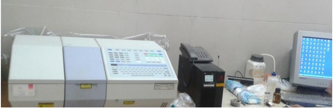
Şekil 3.7. FT-IR analizi için kullanılan cihaz (Spectrum RXI, UK).
