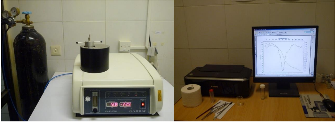
Şekil 3.8. TG analizi için kullanılan cihaz (Linseis STA PT 100).
