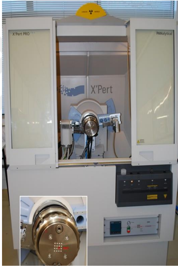
Şekil 3.5. XRD analizi için kullanılan cihaz (Philips Xpert X-ray diffractometer).
