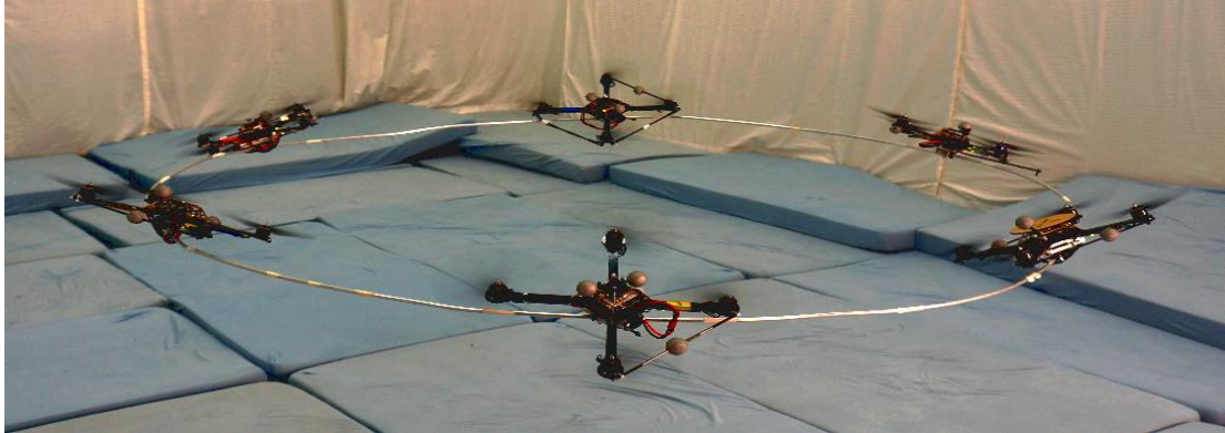
Şekil 2.5 İnce, esnek bir halka taşıyan altı quadrotor (R. Ritz and R. D'Andrea 2013)
