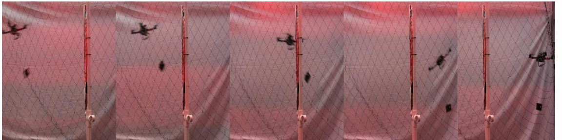
Şekil 2.2 Bir pencereden yük ile geçen quadrotor (Tang and Kumar 2015)
