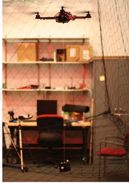
Şekil 2.1 Yük taşıyan Hummingbird quadrotoru (Sreenath et al. 2013)
