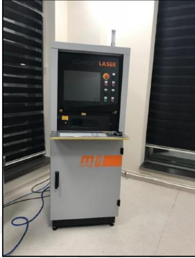
Şekil 3.2. Concept Laser MLab R marka-model SLE cihazı
