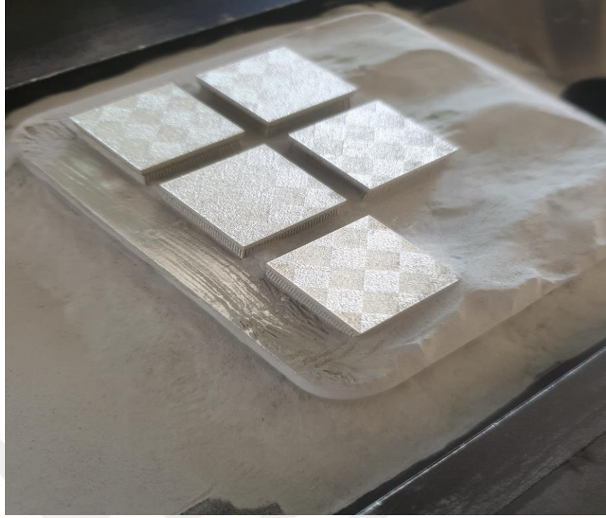
Şekil 3.4.SLE yöntemiyle üretimi tamamlanmış tabla üzerine bağlı destek elemanları ayrılmamış numuneler
