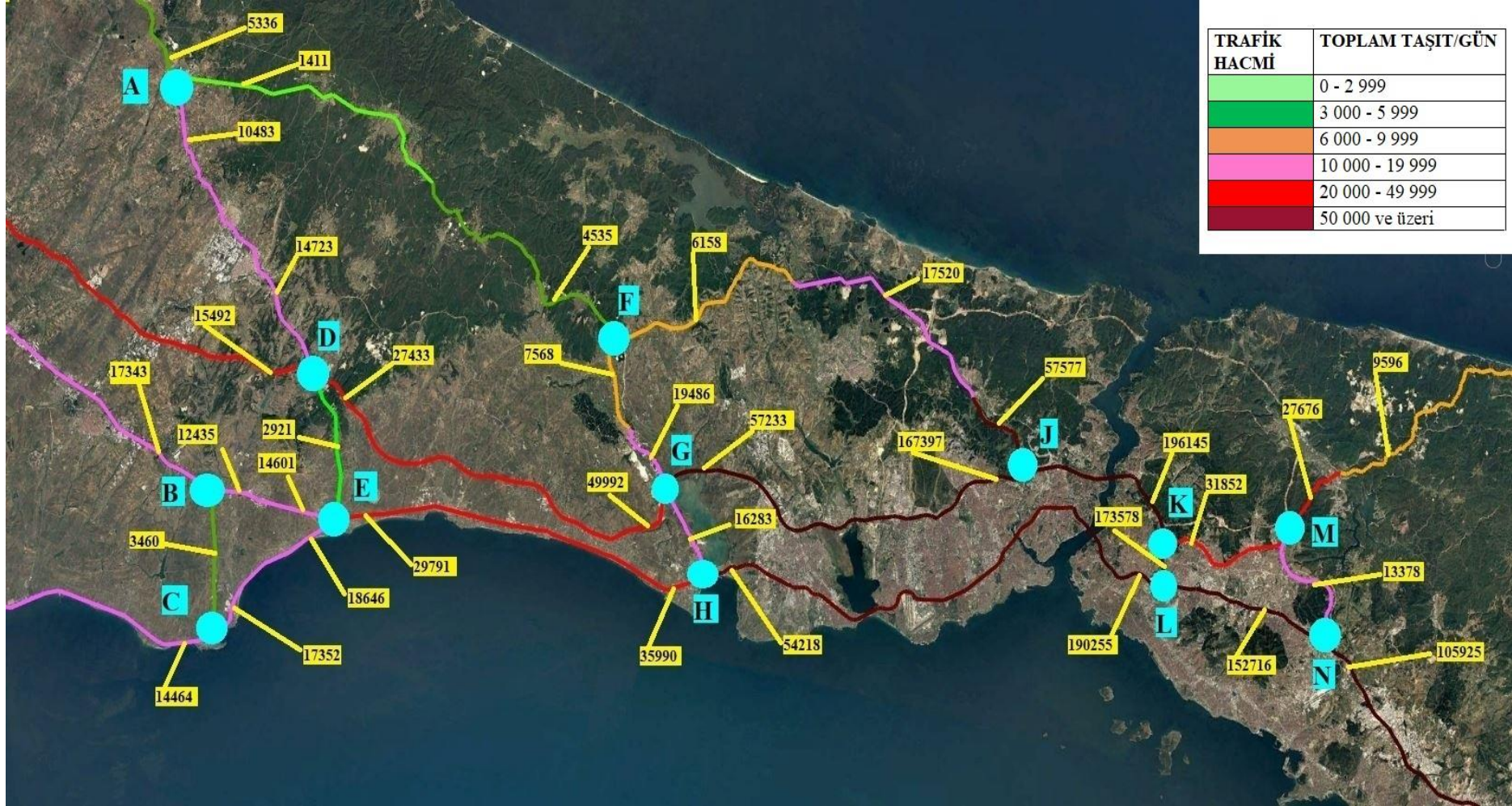
Şekil 4.1 İlk Durum için Yavuz Sultan Selim Köprüsü ve Kuzey Marmara Otoyolu yapımı öncesi trafik hacim haritası
