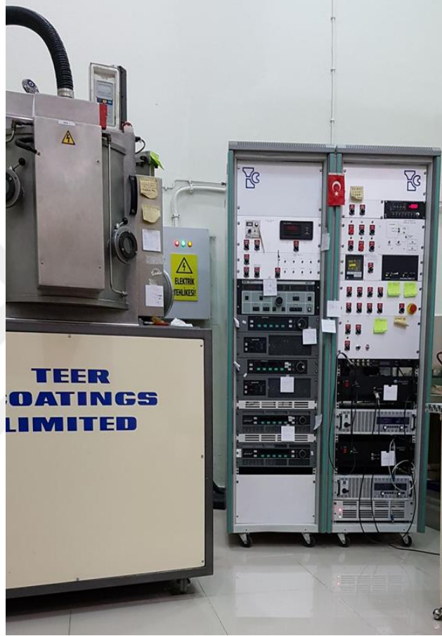
Şekil 3.4. Kapalı alan dengesiz manyetik alanda sıçratma sistemi (CFUBMS)
