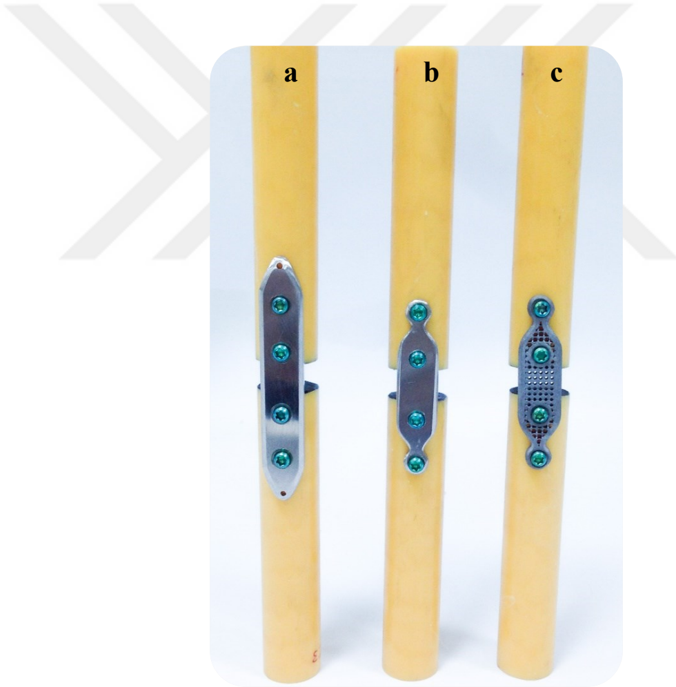
Şekil 3. 10. (a) Geleneksel, (b) optimum ve (c) gözenekli plak-kemik modelleri
