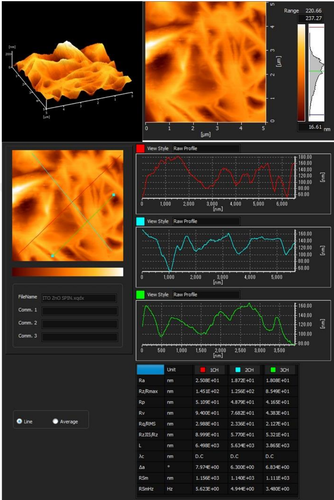
Şekil 4.4. Dönel kaplama (spin coating) cihazı ile cam yüzeyine kaplanmış ZnO ince filminin AFM görüntüleri.
