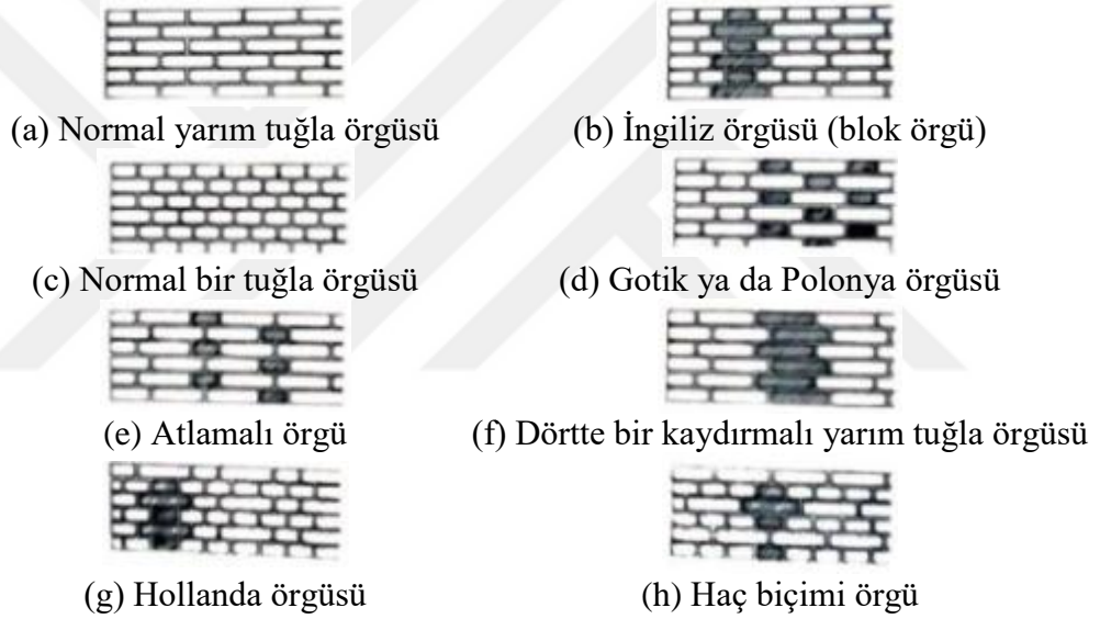
Şekil 1.8. Tuğla duvar örgüleri (Kaya 2010)
