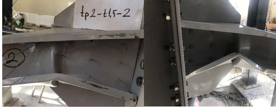
Şekil 4.24. Göçme modu deney Tp2-t1,5-2 (No: 2)
