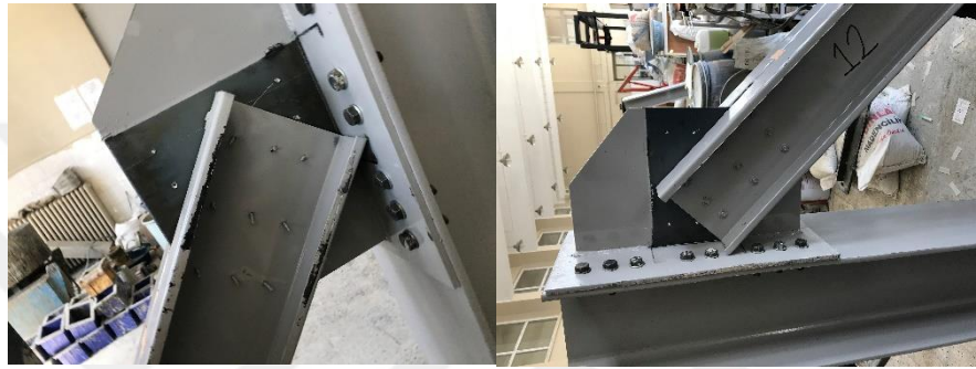
Şekil 4.34. Göçme modu deney Tp4-t2,5-12 (No:12)
