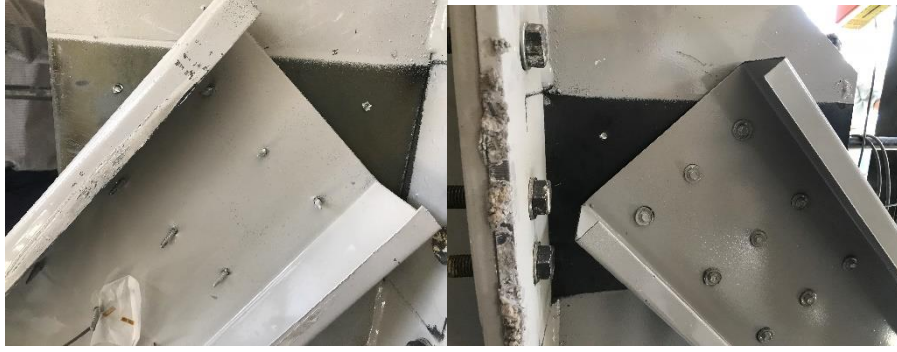
Şekil 4.33. Göçme modu deney Tp4-t2-11 (No:11)
