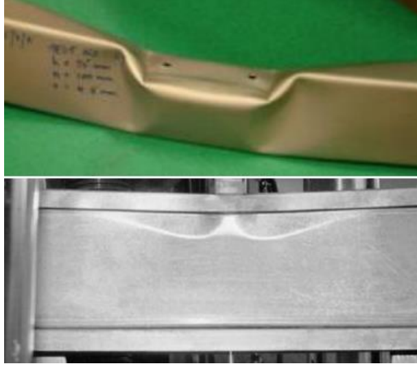
Şekil 1.32. Bir C ve I profilinin yükleme bölgesi altındaki gövde profil buruşması (Öztürk, 2014)
