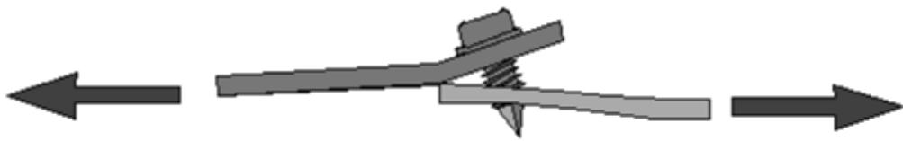
Şekil 1.13. Eğilme ve sıyrıma göçme modu (TC 7 - TWG 7.10 , 2009)
