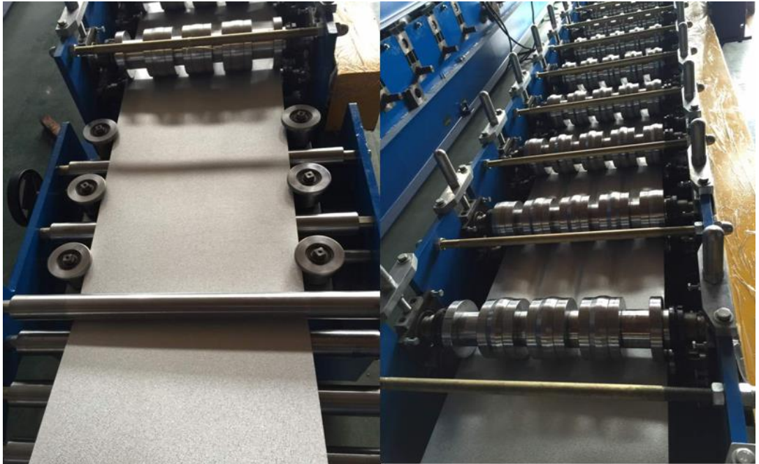
Şekil 1.2. Merdaneli biçimleme makinesi ve soğuk şekil verme sistem elemanları
