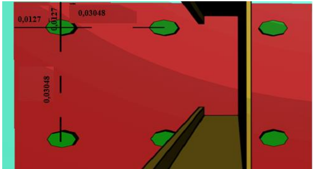
Şekil 4.24: Kiriş-kolon birleşim detayları
