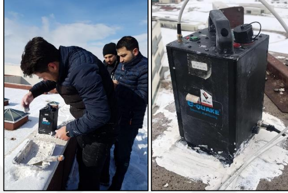
Şekil 3.12 İvmeölçer sensörün alçıyla zemine sabitlenmesi uygulaması
