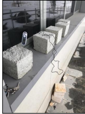
Şekil 3.12 Kış şartlarında kalıptan çıkarılan beton numuneler
