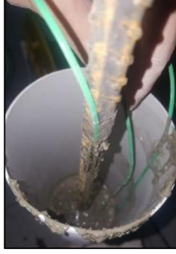
Şekil 3.29 Beton dökümü sırasında termokupl yerleşimi
