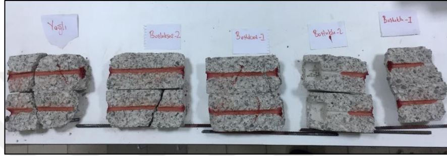
Şekil 4.21 Birinci tip deney numuneleri içi çatlak detayı
