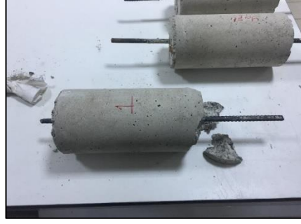
Şekil 4.12 Boşluksuz Numune-1 kırılma şekli
