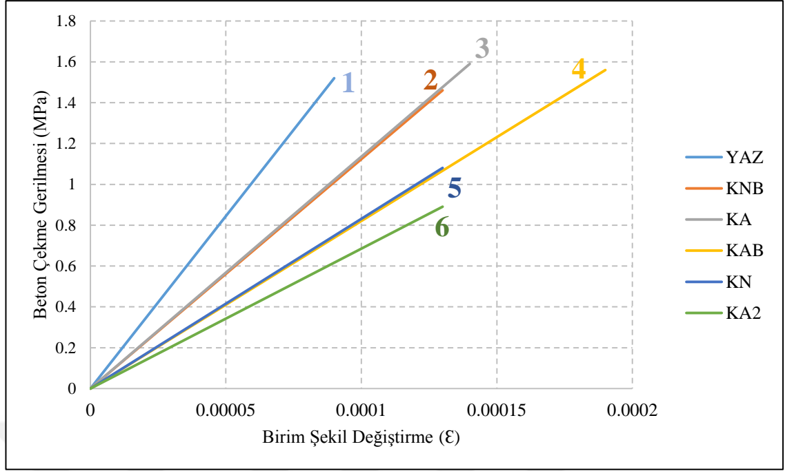
Şekil 4.106 Numune grupları için temsili beton çekme gerilmesi-birim şekil değişirme ilişkileri
