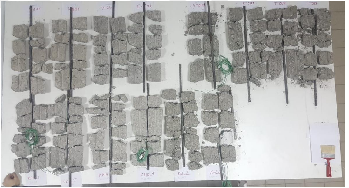
Őekil 4.110 nc tip deney numunesine ait her grubu kapsayan atlak detayı
