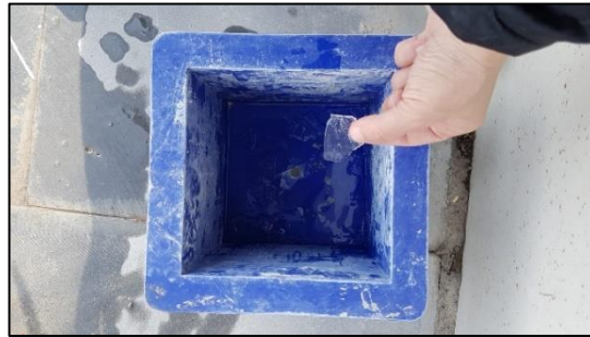
Şekil 3.9 Kış şartlarında bekletilen kalıbın buzlanması
