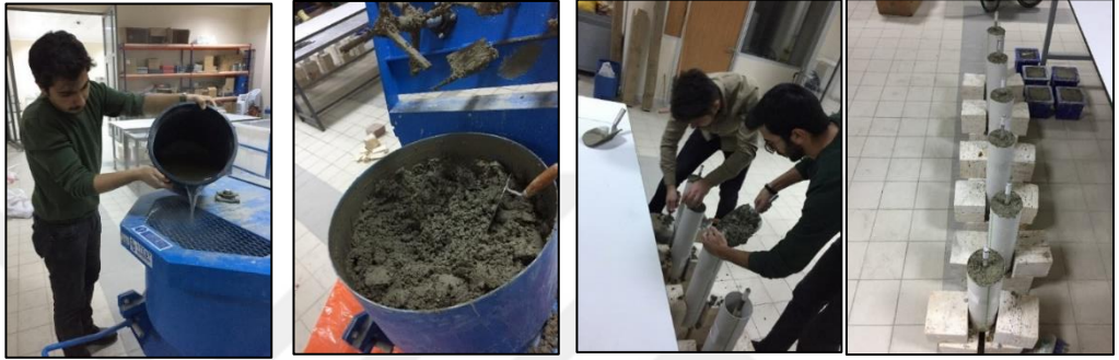
Şekil 3.20 İkinci tip deney numunesi beton dökümünden görüntüler
