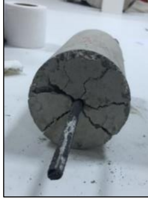
Şekil 4.15 Yağlı Numune deney sonu kırılma mekanizması
