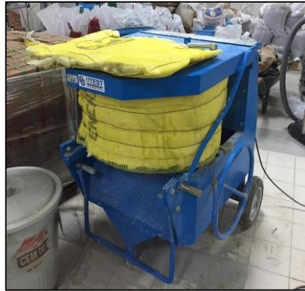
Şekil 3.32 Beton mikseri yalıtım uygulaması
