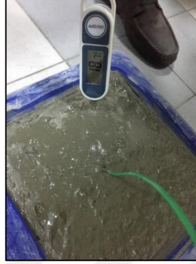
Şekil 3.23 Termokupl sensör testi için beton numune sıcaklık takibi
