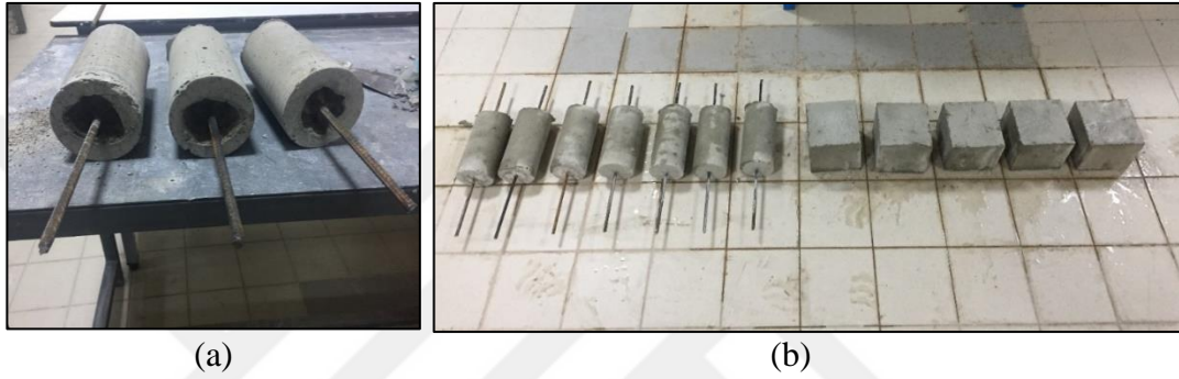
Şekil 3.17 (a) Boşluklu numune detayı (b) Kalıptan çıkarılan birinci tip deney numuneleri
