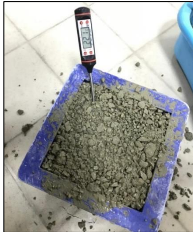
Şekil 3.4 Numune-2 taze beton sıcaklık ölçümü ( 22,1^\circ\text{C} )
