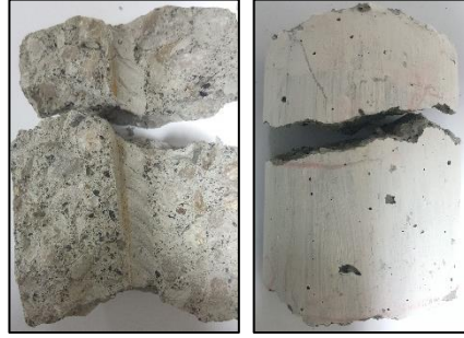
Şekil 4.61 KA grubu numunesi içi çatlak detayı
