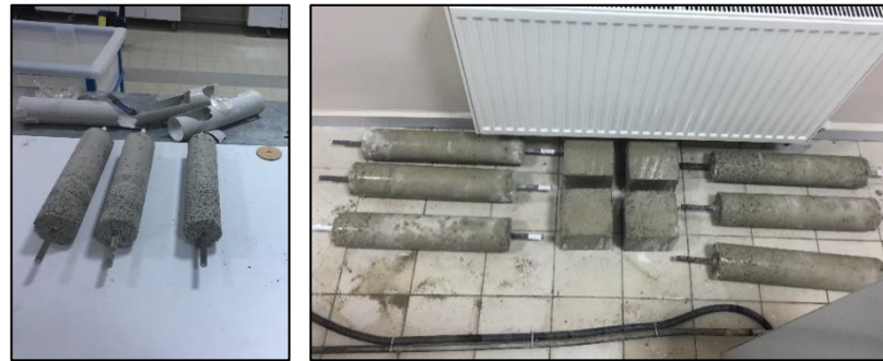
Şekil 3.21 (a) Aderans numunelerinin kalıptan çıkarılması (b) Numunelere kür işleminin uygulanması.
