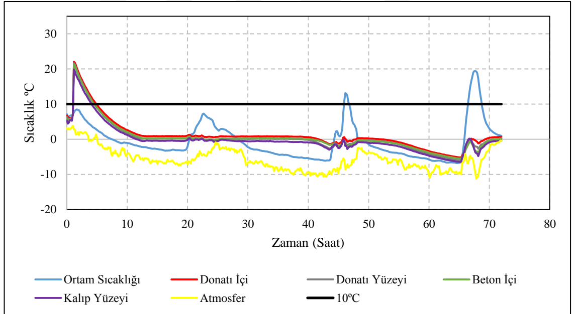
Şekil 4.63 KN grubu aderans numunesi sıcaklık değişim grafiği
