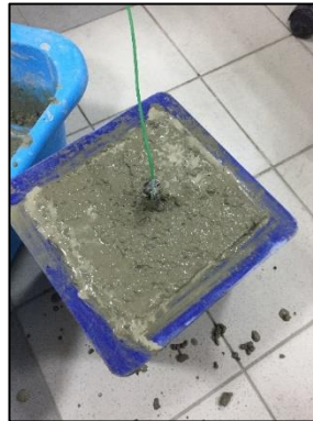
Şekil 3.24 Taze beton içerisindeki donatının sıcaklık takibi
