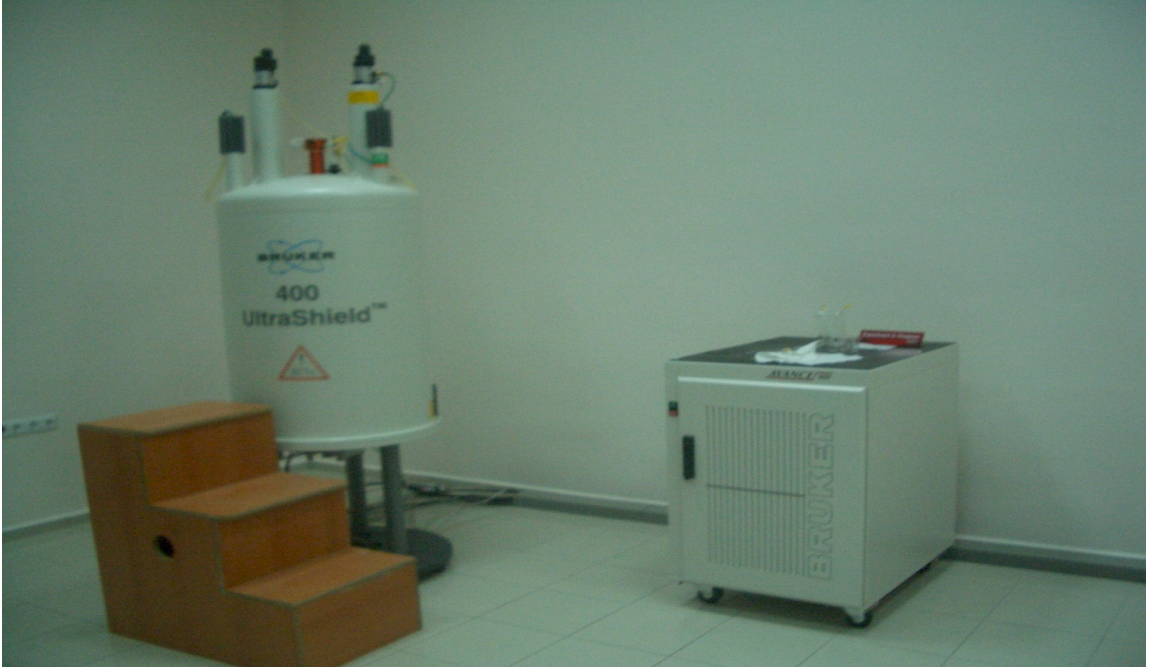
Şekil 4.1. 400 MHz AVANCE-NMR cihazı
