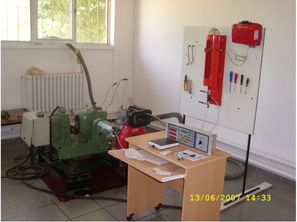
Resim 2. Deneyleerde kullanılan BT-140 model hidrolik dinamometre
