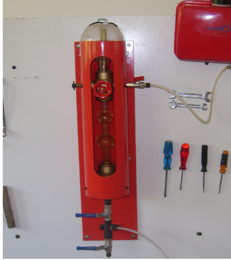
Resim 3. Yakıt tüketimi ölçüm ünitesi
