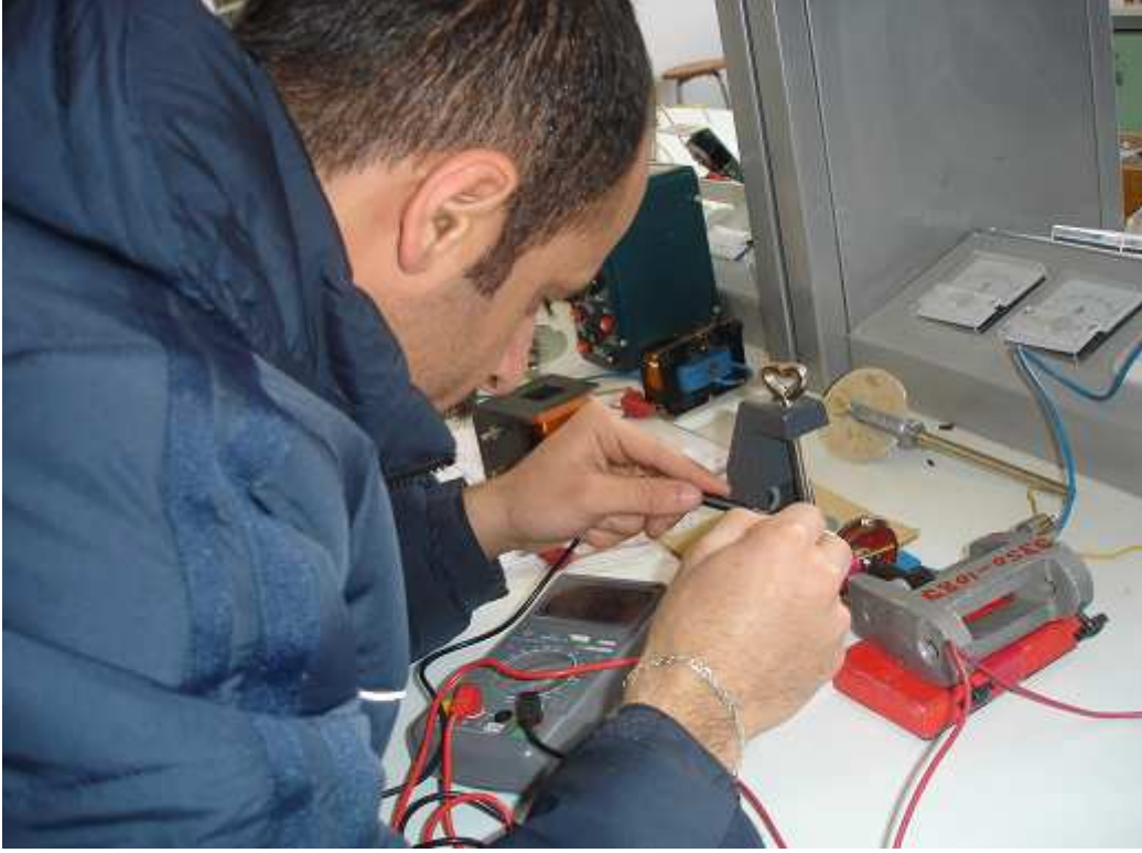
Fotoğraf 5. Deney Grubundaki Öğrenciler Bir Kondansatörün Sığasını Tespit Etmeye Çalışırken
