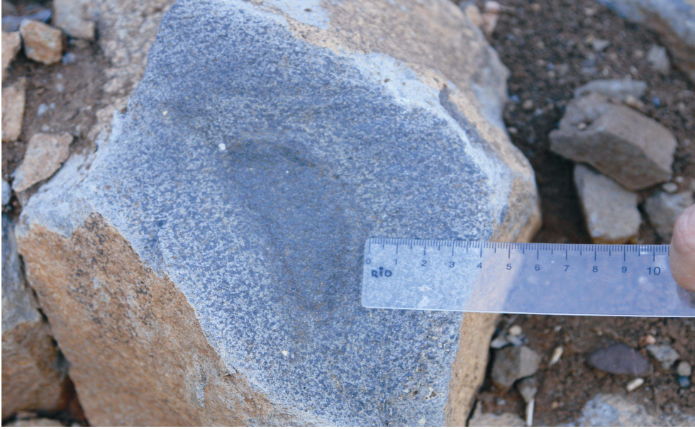
Şekil 3.13. Dönümlü Köyü dolayındaki bazaltlarda gözlenen bozuşmalara bir örnek (bozuşmayan, orta kesim).
