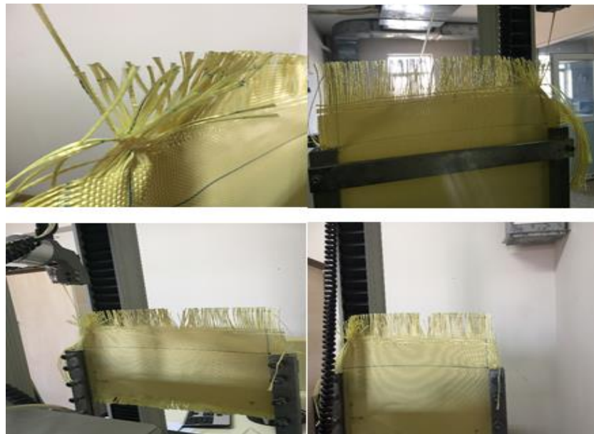
Şekil 3.13. Alttan 6. ipliğin çekiminin yapıldığı numune.
