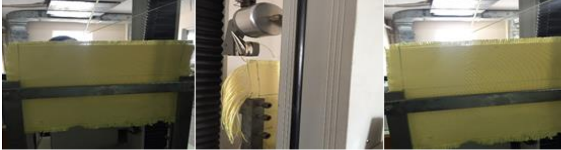
Şekil 3.6. Üstten 1 tane iplik çekiminin yapıldığı numune.
