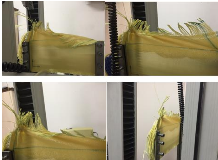
Şekil 3.28. Altan 6. ipliğin çekiminin yapıldığı prepreg numune.
