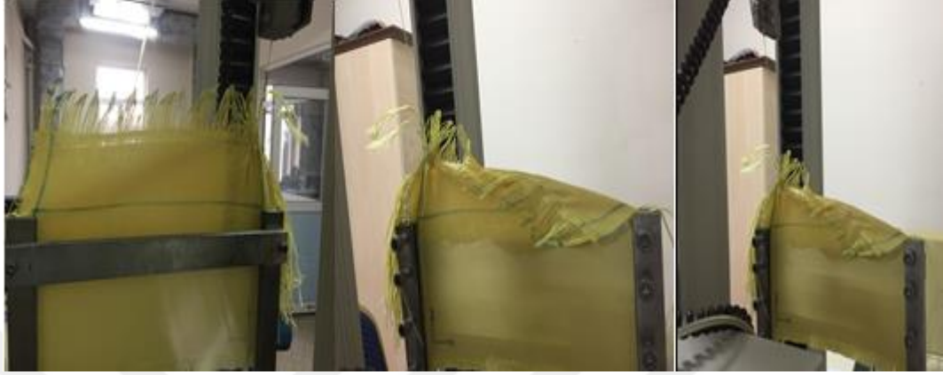
Şekil 3.29. Altan 7. ipliğin çekiminin yapıldığı prepreg numune.
