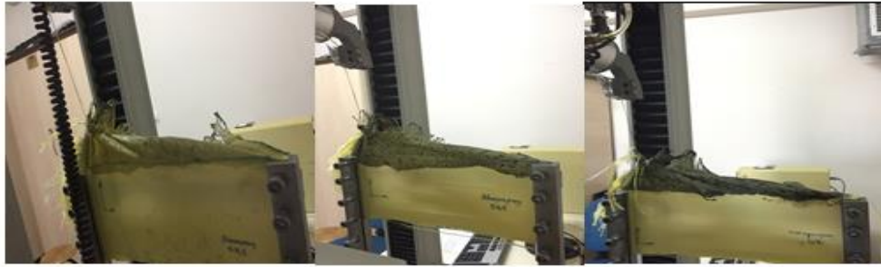
Şekil 3.42. 0,1% (a) , 0,5% (b) ve 0,7% (c) nanoproreg numunelerinin üstten 4 tane iplik bırakılıp 6. ipliğin test sırasındaki görüntüsü.
