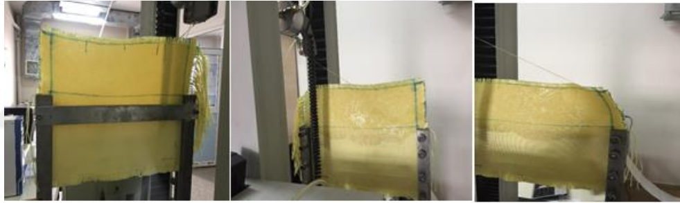
Şekil 3.21. Üstten 1 tane ipliğin çekiminin yapıldığı numune.
