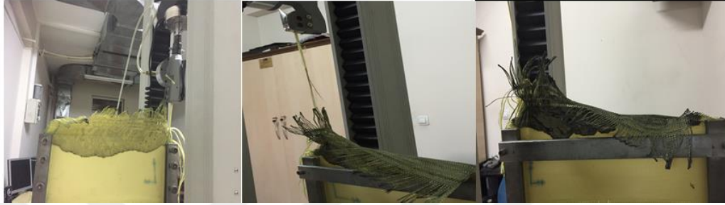
Şekil 3.60. 0,1% (a) , 0,5% (b) ve 0,7% (c) grafenpropreg numunelerinin üstten 4 tane iplik bırakılıp 5-6-7 ve 8. İpliğin test sırasındaki görüntüsü.
