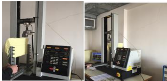
Şekil 3.5. Numunenin Instron Cihazına Yerleştirilmesi.
