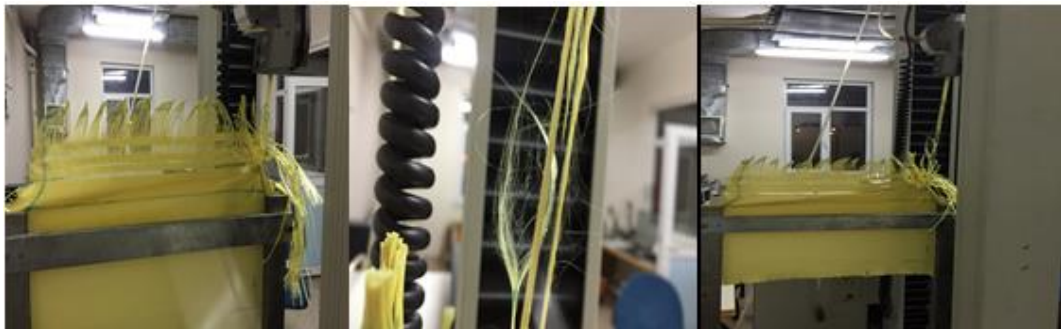
Şekil 3.34. Alttan 5-6-7-8. ipliğin çekiminin yapıldığı prepreg numune.
