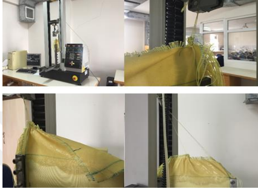
Şekil 3.23. Üstten 3. ipliğin çekiminin yapıldığı numune.
