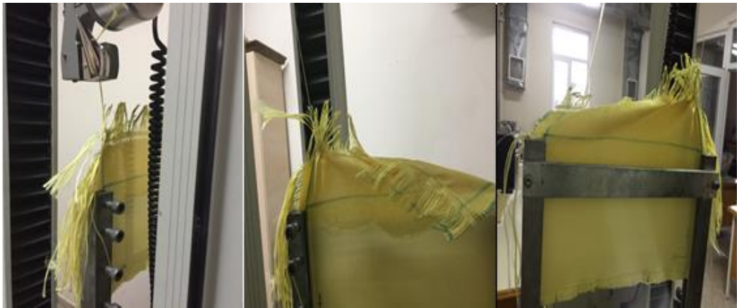
Şekil 3.30. Altan 8. ipliğin çekiminin yapıldığı prepreg numune.
