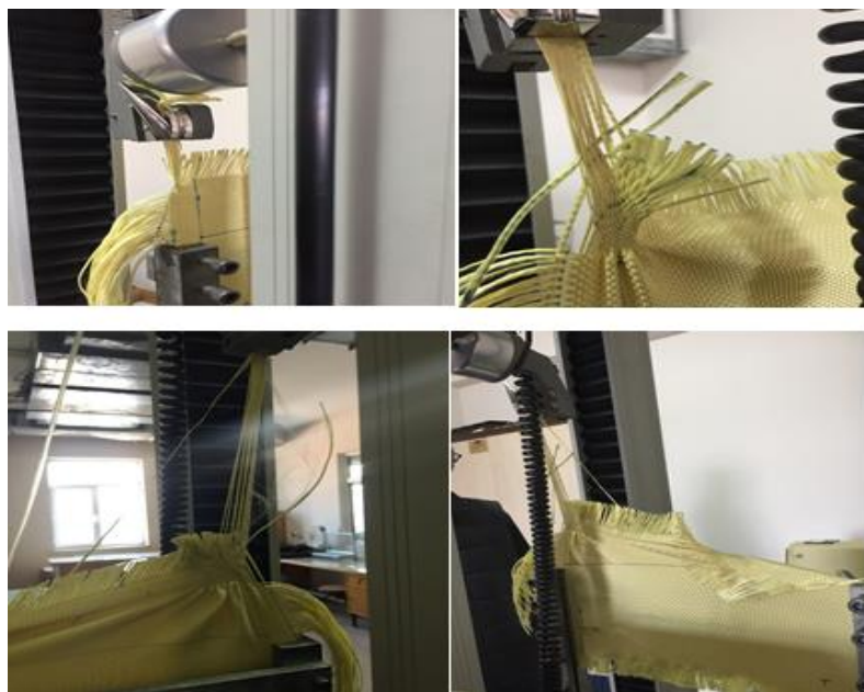
Şekil 3.11. Üstten 12 tane iplik çekiminin yapıldığı numune.
