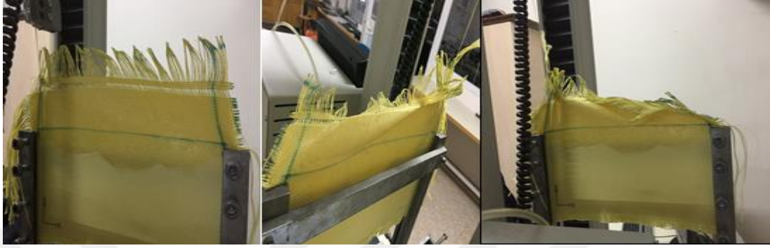
Şekil 3.31. Alttan 9. ipliğin çekiminin yapıldığı prepeg numune.
