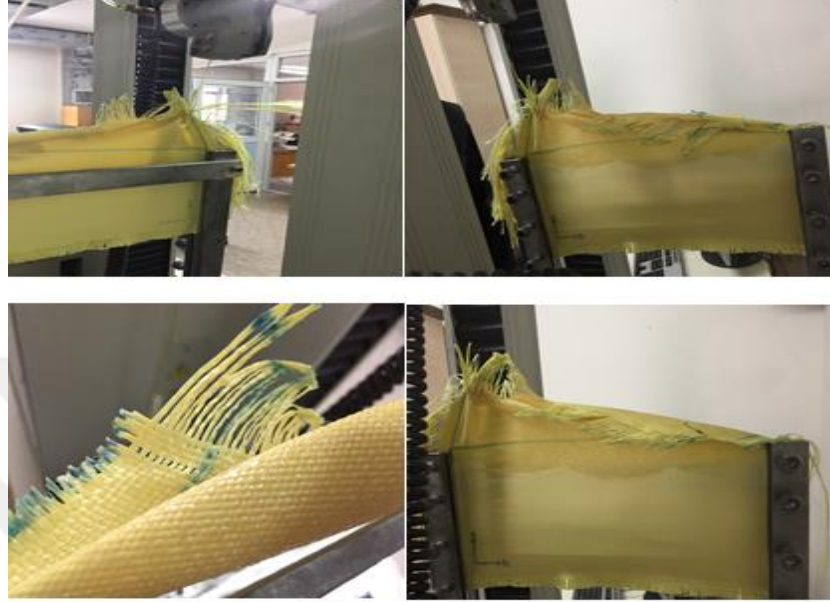
Şekil 3.27. Altan 5. ipliğin çekiminin yapıldığı prepreg numune.
