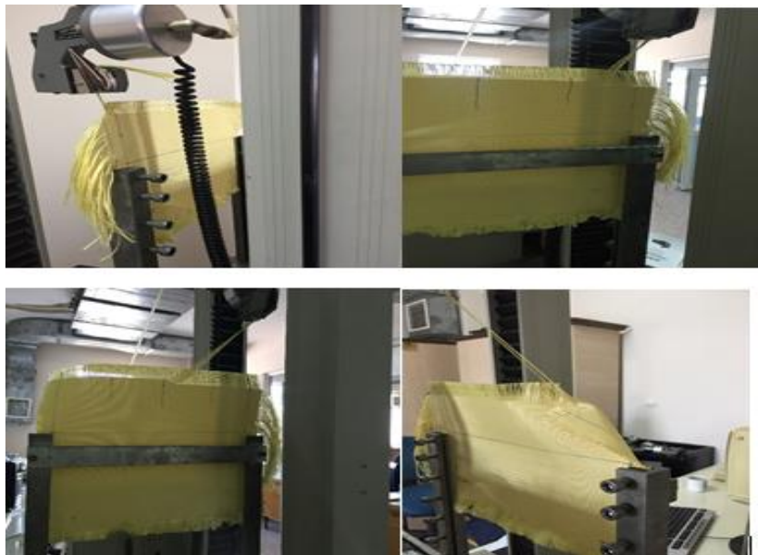
Şekil 3.9. Üstten 4 tane iplik çekiminin yapıldığı numune.
