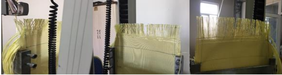
Şekil 3.14. Alttan 7. ipliğin çekiminin yapıldığı numune.
