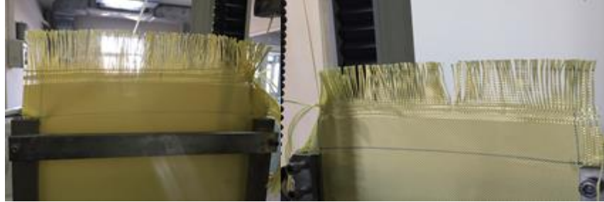
Şekil 3.16. Alttan 9. ipliğin çekiminin yapıldığı numune.
