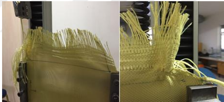
Şekil 3.19. Alttan 5-6-7-8. ipliğin çekiminin yapıldığı numune.
