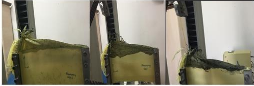
Şekil 3.41. 0,1% (a) , 0,5% (b) ve 0,7% (c) nanoproreg numunelerinin üstten 4 tane iplik bırakılıp 5. ipliğin test sırasındaki görüntüsü.
