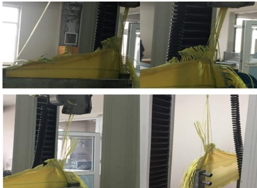
Şekil 3.26. Üstten 12. ipliğin çekiminin yapıldığı prepeg numune.
