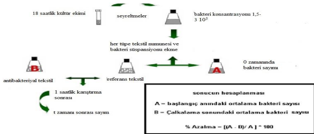
Şekil 3.4 ASTM 2149 testinin şematize edilmesi
