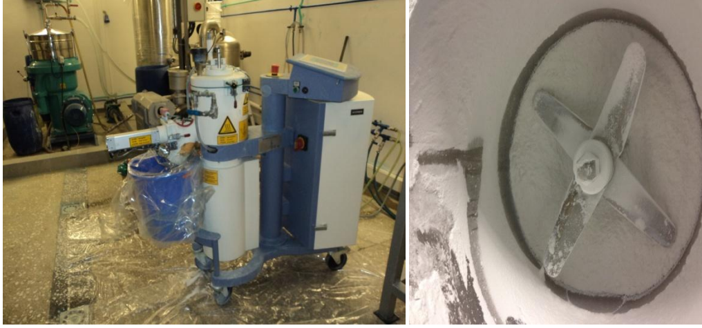
Şekil 4.10 ekstrüder öncesi malzemelerin yüksek hızla karıştırılması a) Henschel Karıştırıcı b) Karıştırma sonrası görünüm
