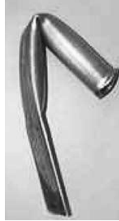
Şekil 2.5 Global burkulmaya uğramış bir enerji yutucu [20]
