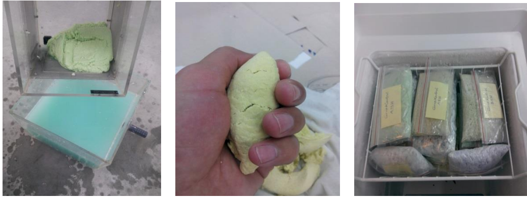
Şekil 3.17 Kesafet artırma ve soğutucuda saklama işlemi
