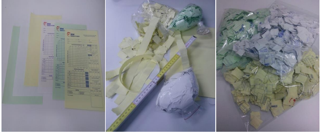
Şekil 3.1 Çalışmada baz kağıt olarak kullanılan otokopi kağıtları
