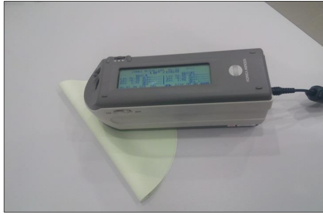
Şekil 3.23 Test kağıtlarına ait CIE L*a*b* renk değerlerinin ölçümü
