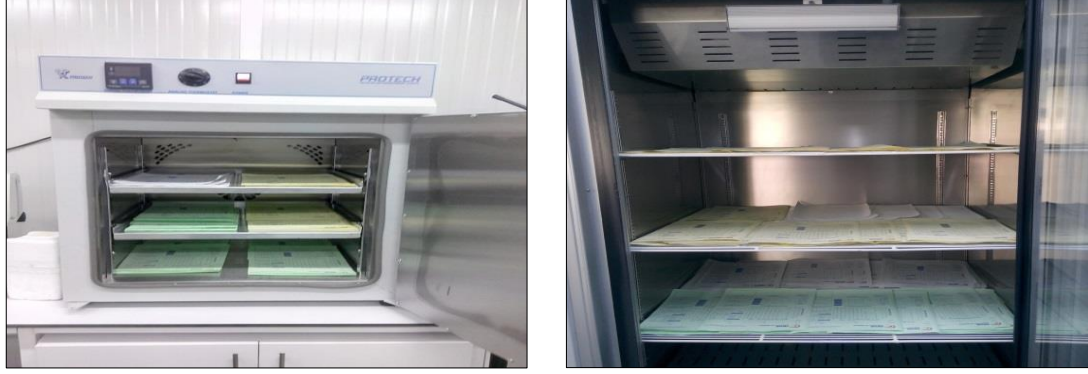
Şekil 3.11 Hızlandırılmış ısıl yaşlandırma ve iklimlendirme işlemi
