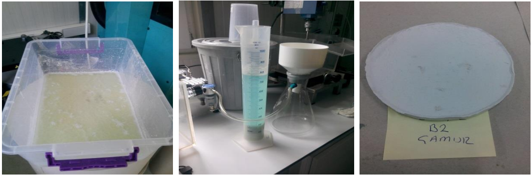
Şekil 3.19 Çamur taslağın oluşturulma işlemi
