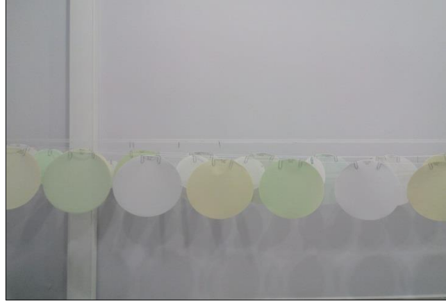
Şekil 3.24 Test kağıtlarının şartlandırılması
