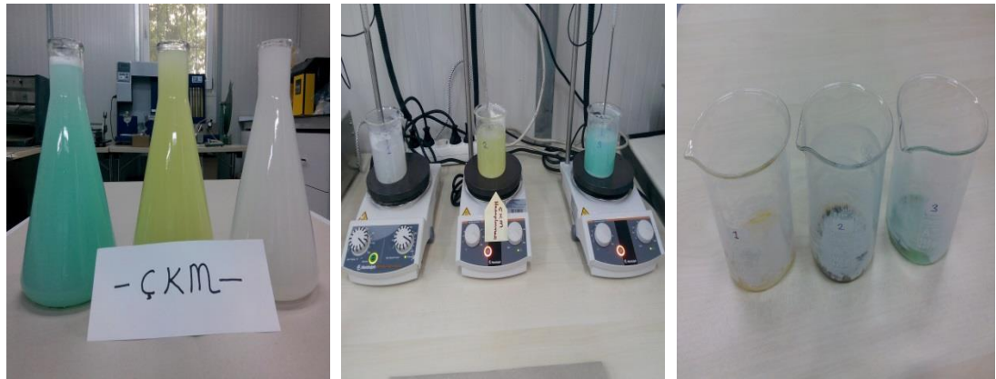
Şekil 3.21 Atık su içerisindeki Çözülmüş Katı Madde (ÇKM) hesaplanması
