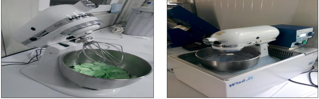
Şekil 3.13 Hobart tipi pulper ve hamurlaştırma işlemi
