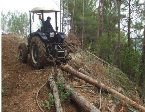
Şekil 1.11 Tarım traktörünün asli orman ürünlerini sürütme şeridi üzerinde sürütmesi[9]
