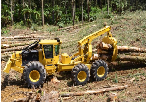
Şekil 3.2 Tigercat 635D ile sürütme çalışması (sol) ve operatör kabini (sağ)
