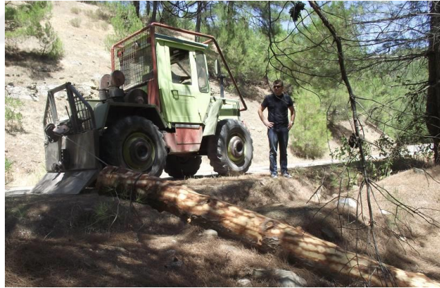
Şekil 1.16 Orman traktörüyle bölmeden çıkarma [9]
