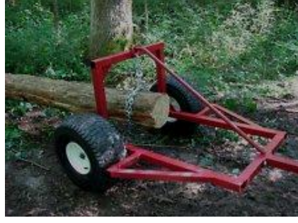
Şekil 1.9 Sürütme arabası (sol) ve sürütme teknesi (sağ) ile bölmeden çıkarma [9]
