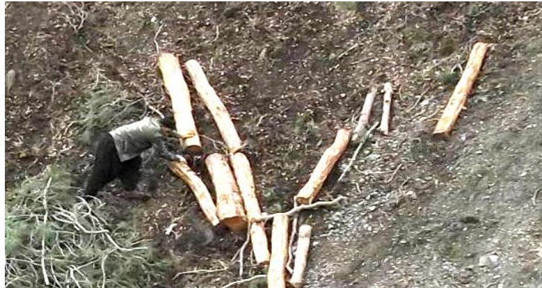
Şekil 1.4. Doğrudan zemin üzerinde kaydırma suretiyle bölmeden çıkarma
