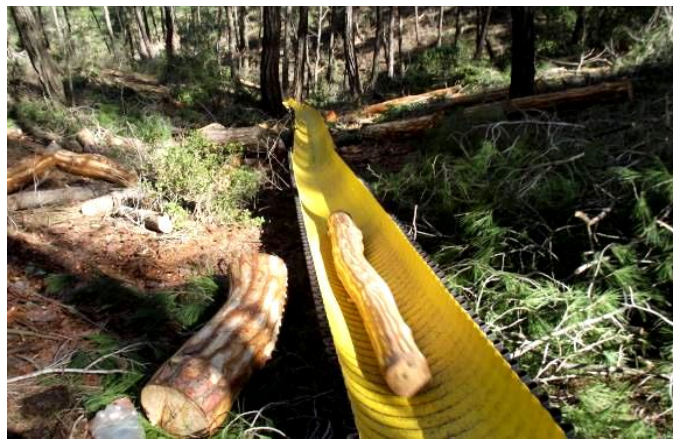
Şekil 1.8 Plastik oluk sistemi ile bölmeden çıkarma çalışması (Foto: N. Gülcü)
