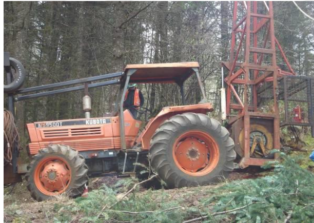
Şekil 1.15 Tarım traktörüne monte edilen Koller K300 vinçli hava hattı [9]
