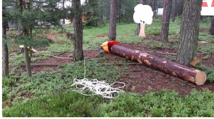
Şekil 1.7 Sürütme konisi (Foto: D.Özkan, KWF 2016, Almanya)
