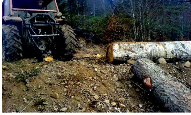
Şekil 1.12 Tarım traktörünün kablo çekimiyle asli orman ürünlerini çekmesi [9]
