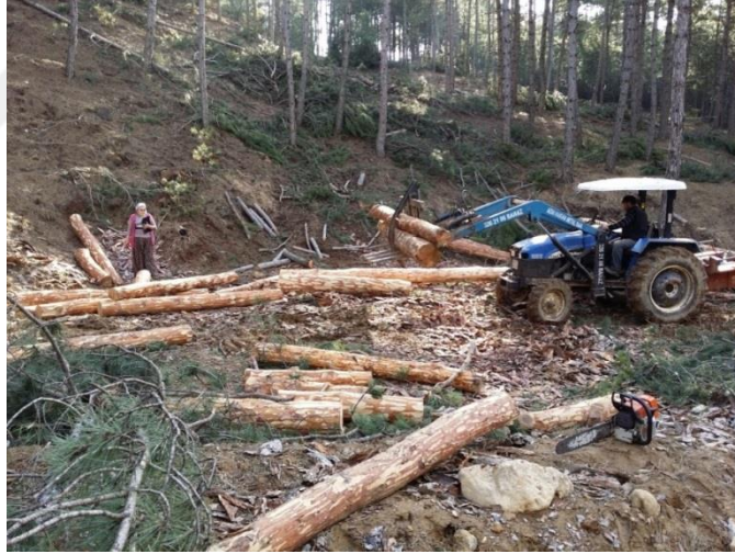
Şekil 1.13 Tarım traktörlerinin yükleyici olarak kullanılması (Foto:D.Özkan, Uşak 2016)
