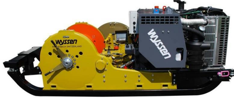
Şekil 1.26 WYSSSEN marka uzun mesafeli vinçli hava hattı kızağı ve motor
