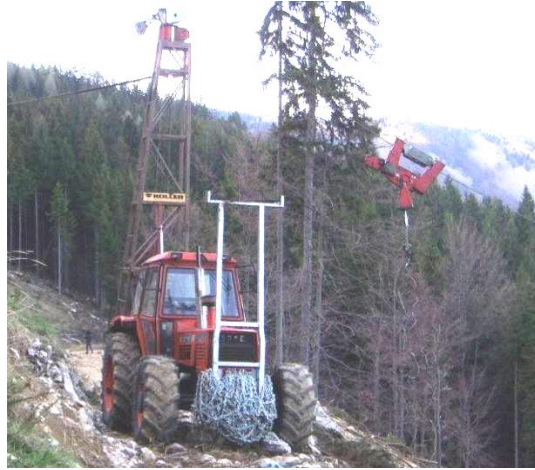
Şekil 1.24 Koller K300 kısa mesafeli mobil vinçli hava hattı
